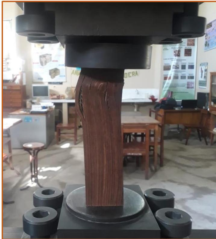
Se aplica sobre la sección transversal de la probeta una carga continua de tal manera que el plato móvil avance a una velocidad constante de 0,6 mm/min; con el deflectómetro se mide la deformación producida en la probeta, así mismo se registra la carga que fue aplicada hasta producir la falla en la probeta.
