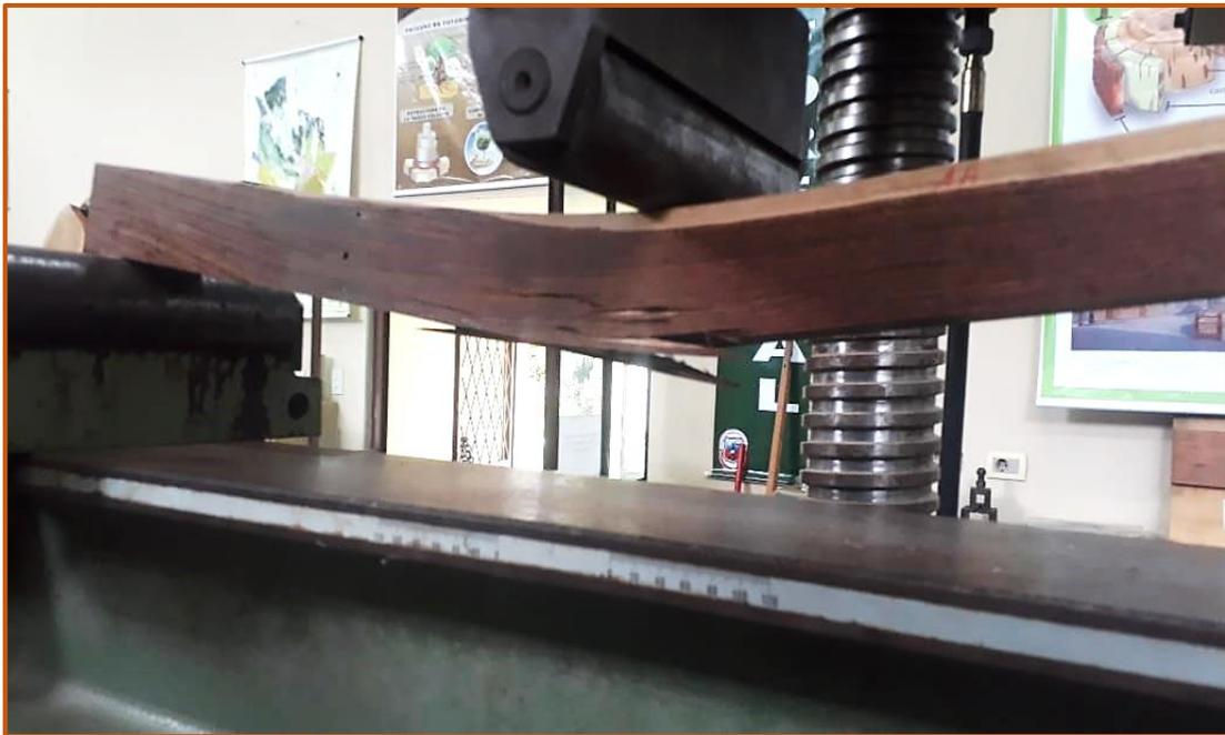
Para la identificación de la falla se aplicó el clasificador de flexión estática. El contenido de humedad se determinó directamente con ayuda del Xilohigrómetro digital.
