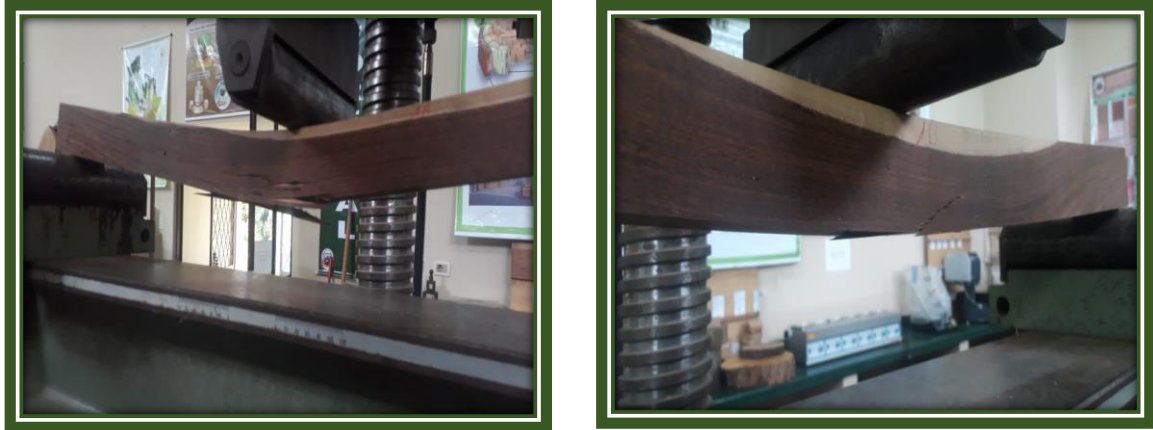
Foto 2: Ensayo de Flexión Estática
