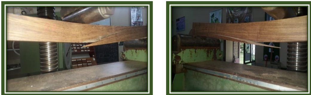
Foto 3: Fallas y pesaje de probetas
