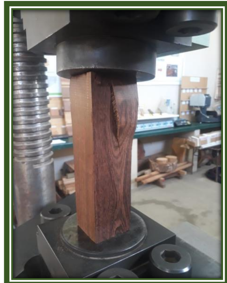
Foto 5: Compresión paralela al grano
