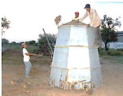
Hornos metálicos tipo CEVAG-INIFAP de forma cónica de 3 niveles
