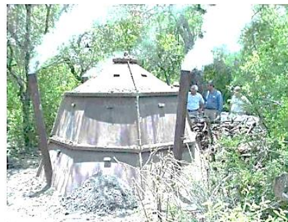
Hornos metálicos de forma cónica de 2 niveles
