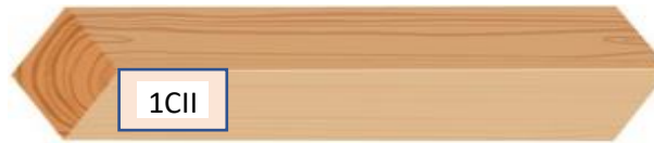
Figura N° 4: Codificación de las viguetas
