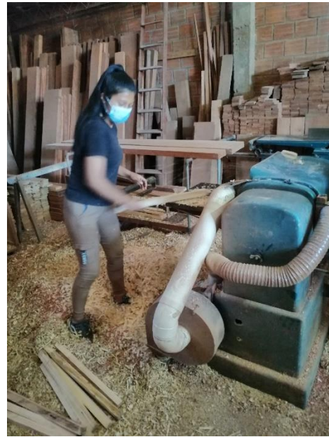
Viguetas sometidas a la gruesadora
