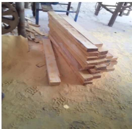
Fotografía N° 6 Obtención de probetas en sobre medida de cepillado y lijado.
