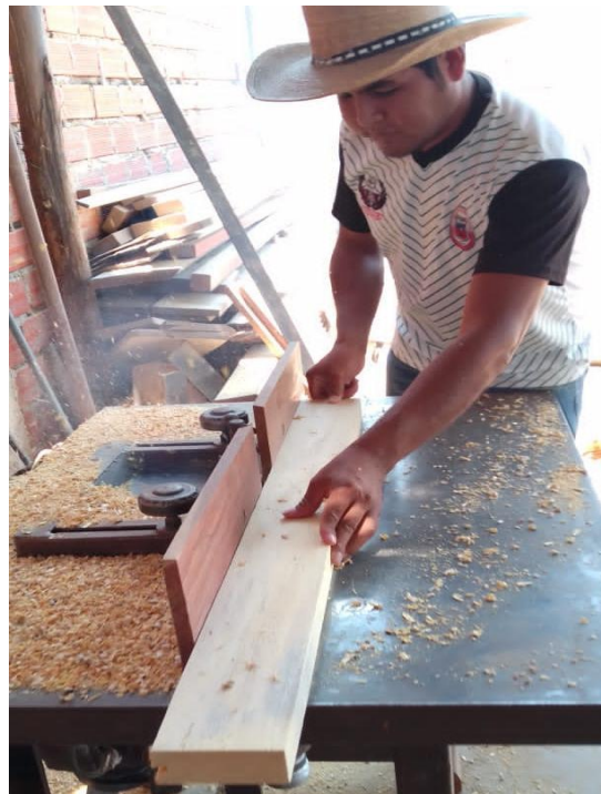
Fotografía N° 11 Ensayo de moldurado.
