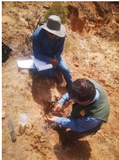
Toma de datos de los diferentes perfiles de la calicata, usando agua se puede identificar las características internas del suelo
