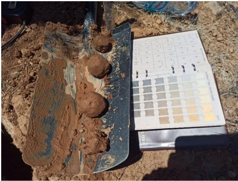
Toma de muestras de la calicata de los diferentes perfiles para la identificación del tipo de suelo
