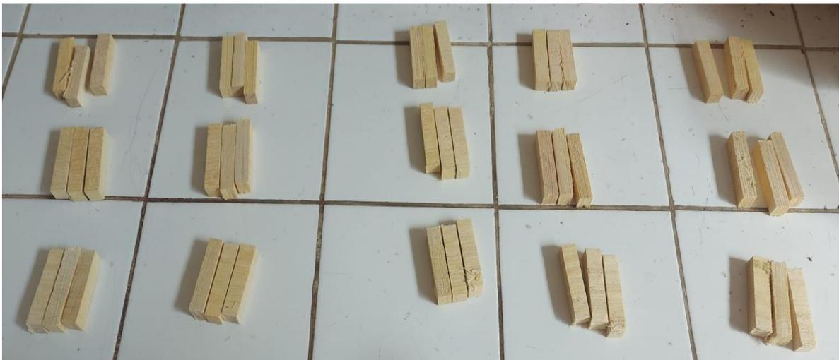
**Fotografía 9.** Ablandamiento y Codificación de las Probetas
