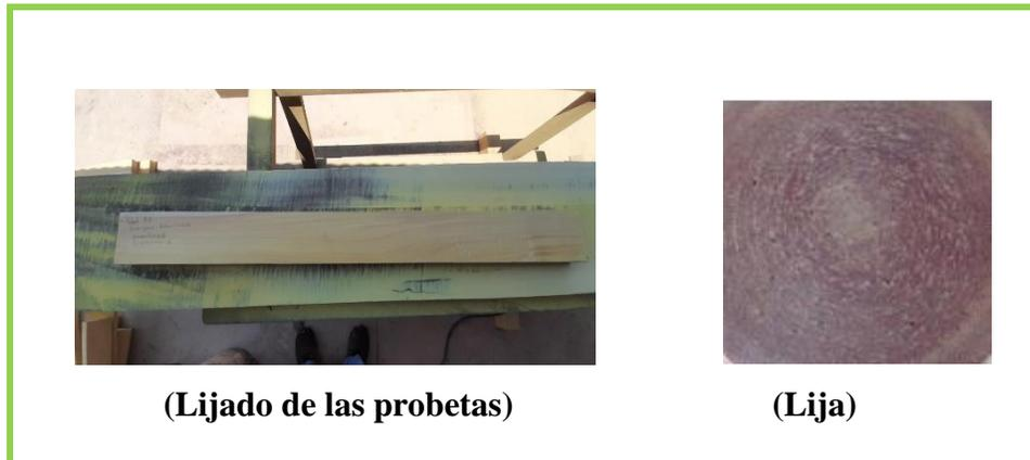
**(Lijado de las probetas)**
