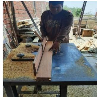
**(Moldurado de probetas)**
