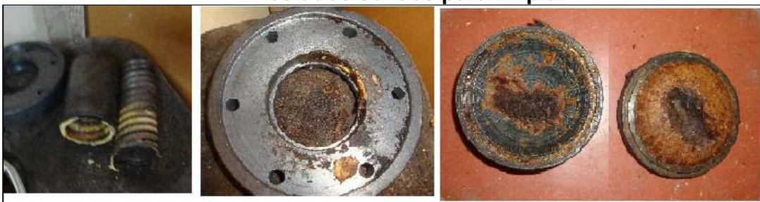
La limpieza del equipo se realiza por calcinación de los residuos que quedan dentro del tornillo, estos residuos son restos de harina y torta de soya; lo que se hace después de concluido el proceso, es la quema de torta de soya, alta en proteína, que se plastifica y facilita el deslizamiento de la camisa y el tornillo, para ser sometido a llama directa hasta calcinarla por completo y así facilitar su limpieza, como lo muestra la figura 3.8.
