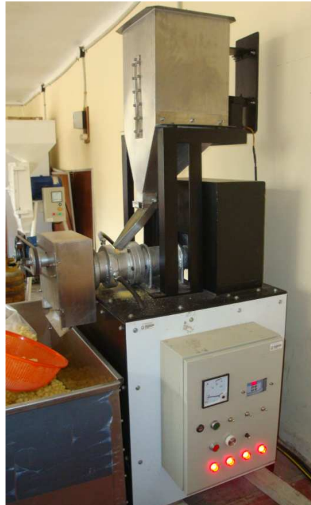
Figura A.1 Extrusor
