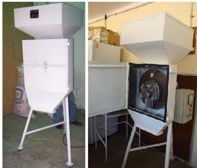
Figura A.2 Molino de martillos
