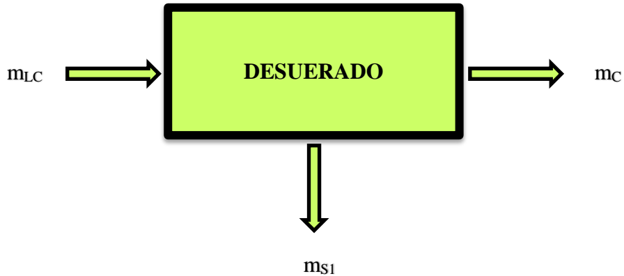
Figura 4.14: Diagrama de bloque en la etapa de desuerado
