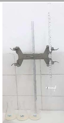
Soporte y bureta de 20 ml con separación en décimas utilizada en la titulación
