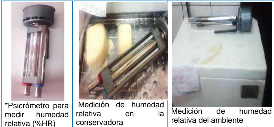
\*Psicrómetro para medir humedad relativa (%HR)
