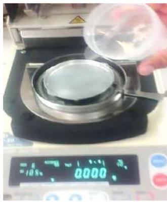
Pesado de la muestra en la balanza de humedad
