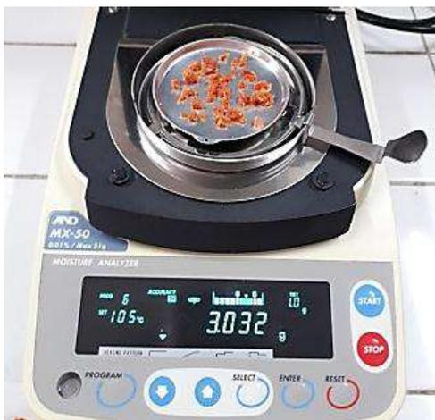
determinación de humedad del chorizo parrillero en la balanza de humedad
