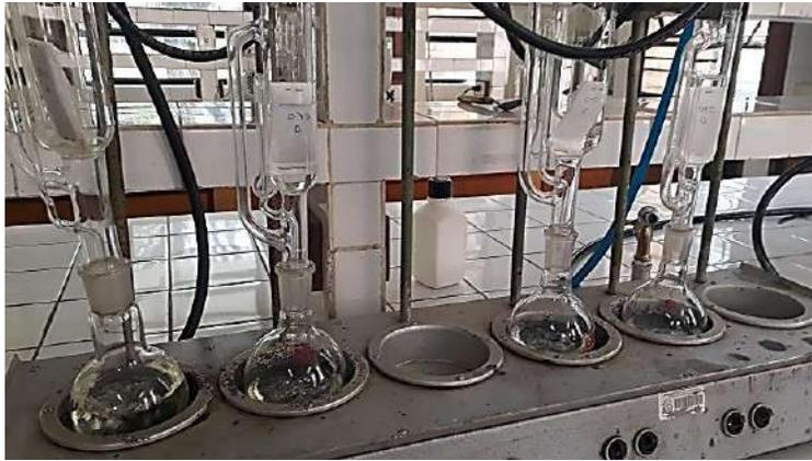
Extracción de la grasa por el método de Soxhlet
