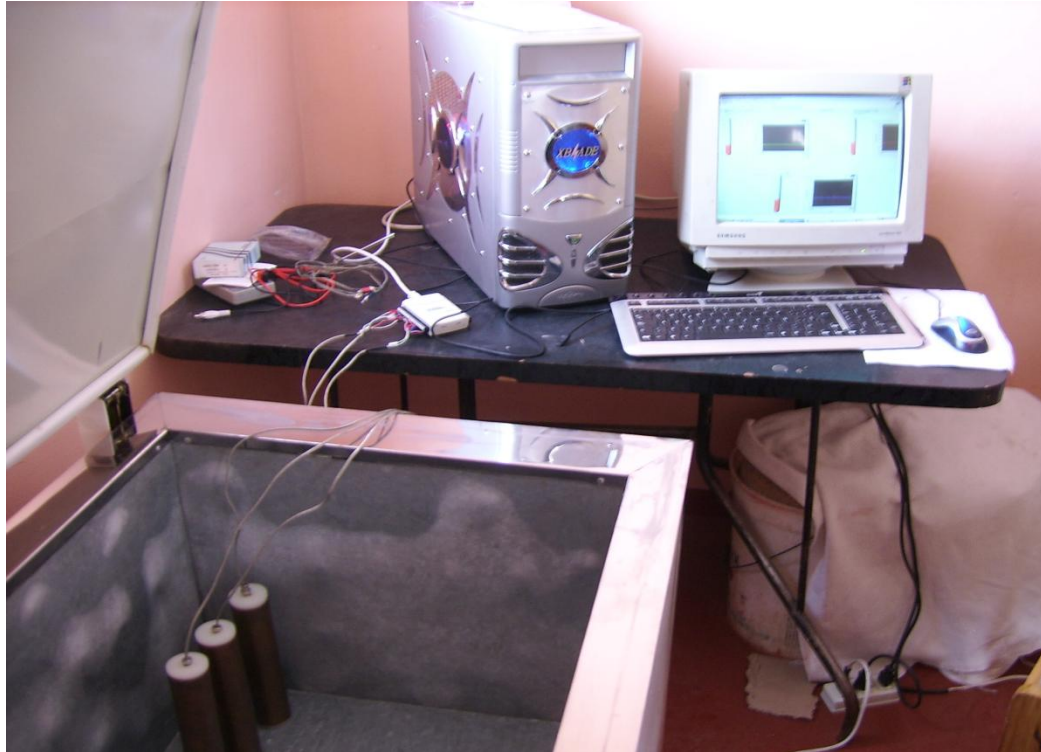
FIGURA 3.5. ESQUEMA DE LA INSTALACIÓN UTILIZADA PARA LA DETERMINACIÓN DE LA DIFUSIVIDAD TERMAL.
