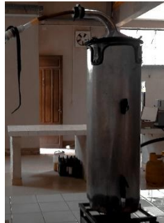
Figura 3.3 Torre de destilación
