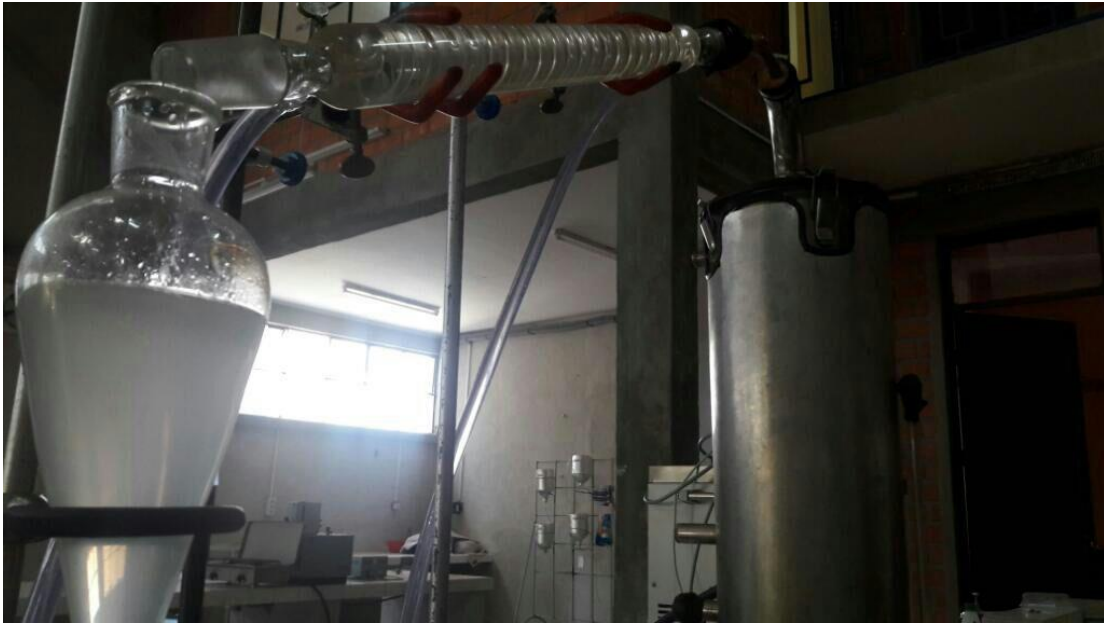
Figura D7 Extracción del aceite esencial de cedrón
