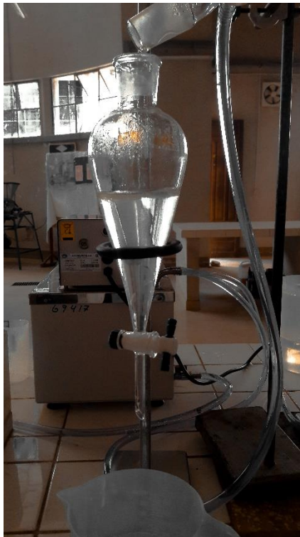
Figura D8 Decantación del aceite esencial de cedrón
