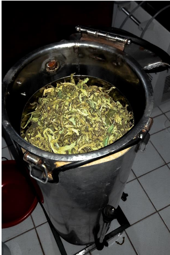
Figura D6 Torre de destilación con la carga vegetal
