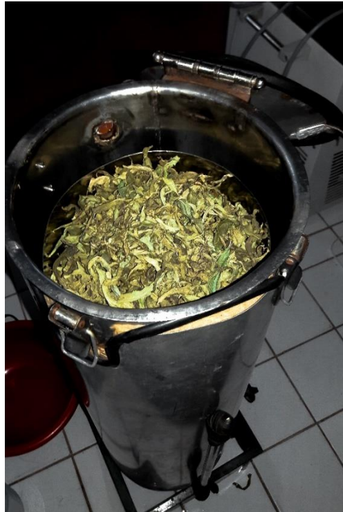
Figura D9 Torre de destilación al finalizar la extracción
