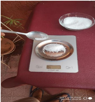
Ilustración 2 Pesaje de 10g Urea, 15g Levadura
