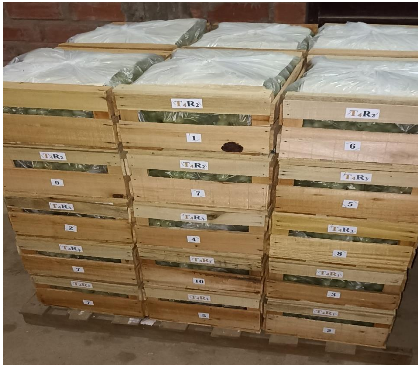
Anexo N°7: Paletizado de Cajas sellada antes del ingreso al túnel de Refrigeración
