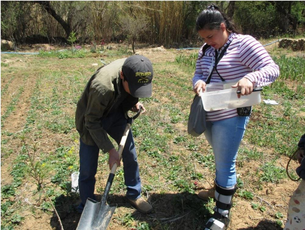
**Corte de 3cm de espesor para la recolección de la submuestra de suelo**
