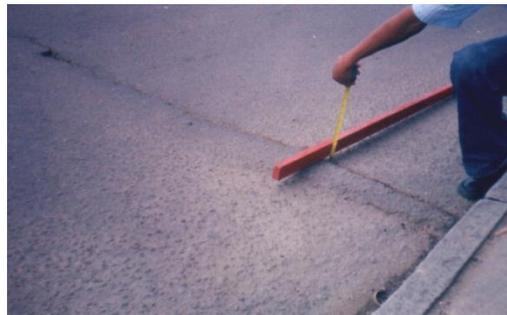
**Figura 3.11. Elevaciones y Hundimientos**
