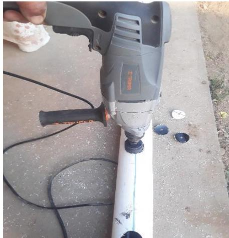
**Figura N°5. Perforación de los tubos de pvc**
