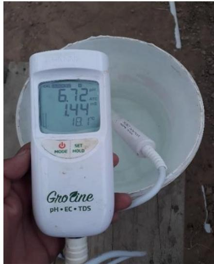
**Figura N°14. Medición de Ph**
