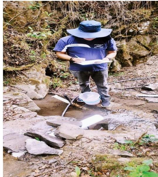
Anexo 4. Medición del caudal del reservorio por el método volumétrico
