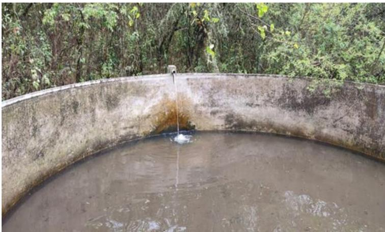
Anexo 3. Medición del caudal de la vertiente por el método volumétrico
