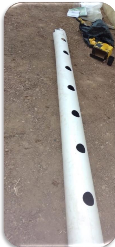
Perforación de orificios para los canastillos
