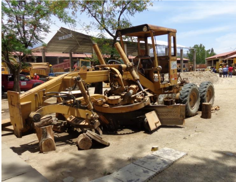
Usos de troncos como gatas, para realizar las reparaciones
