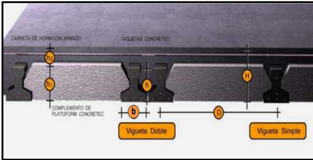
Figura 2. 11. – Losa Aliviada con Viguetas pretensadas
