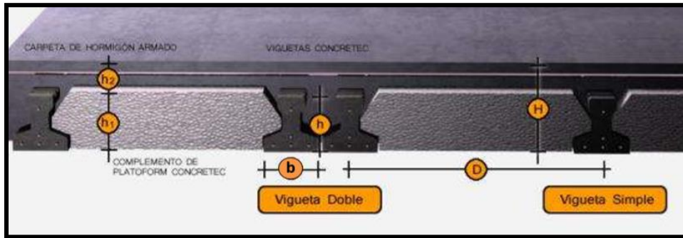
Figura 3. 14. – Sistema de Aplicación de la Vigueta Pretensada
