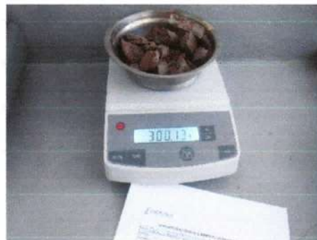
Pesaje de muestra para granulometría en balanza de precisión 0,01 gr.
