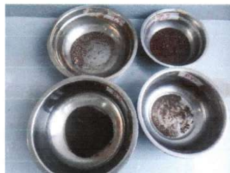
Lavado de muestras por tamiz N°200, posterior secado de muestras en horno a temperatura 110\pm 5\text{ }^{\circ}\text{C} .
