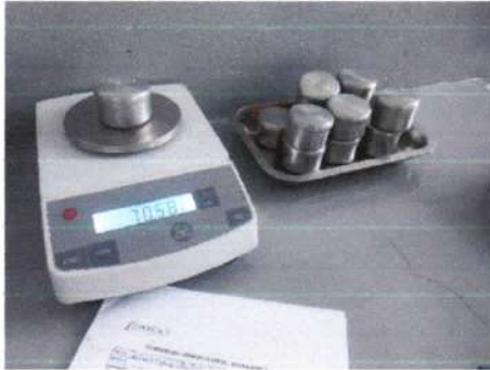
Toma de datos para contenido de humedad, posterior secado de muestras en horno a temperatura 110\pm 5\text{ }^{\circ}\text{C}
