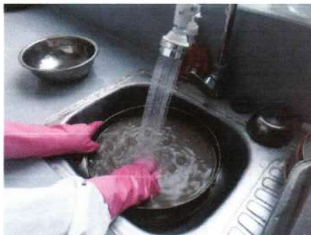
Lavado de muestras por tamiz N°200, posterior secado de muestras en horno a temperatura 110\pm 5\text{ }^{\circ}\text{C} .
