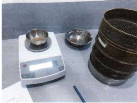
Granulometría por tamizado y pesaje de suelo retenido en balanza de precisión 0,01 gr.
