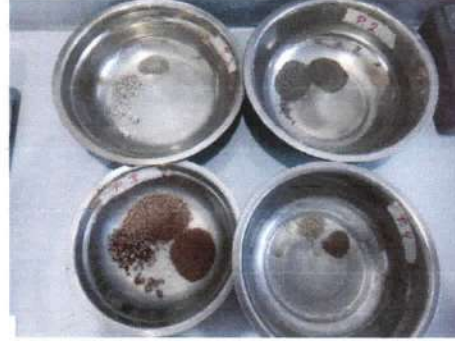
Granulometría por tamizado y pesaje de suelo retenido en balanza de precisión 0,01 gr.
