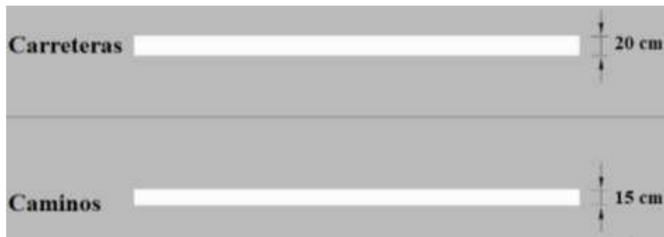
Figura 13: Dimensiones de demarcación continua
