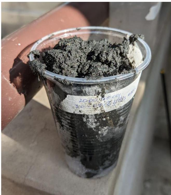
*Figura 2: Muestra de lodo recién procesado de la planta de tratamiento San Blas – Tarija.
