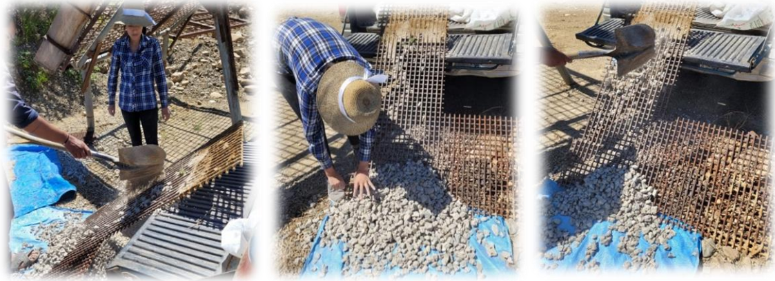
Figura 25. Cernido del material triturado
