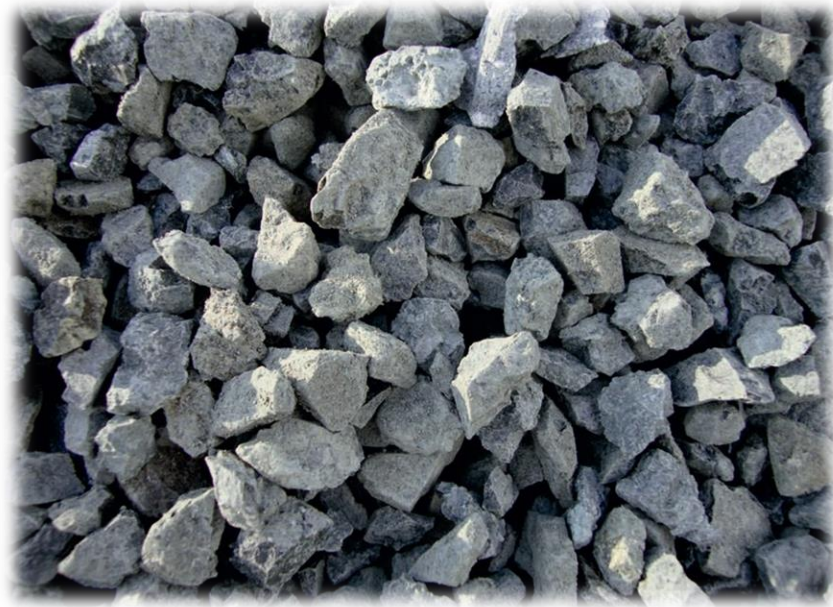
Figura 18. Forma y textura de agregado grueso de concreto reciclado
