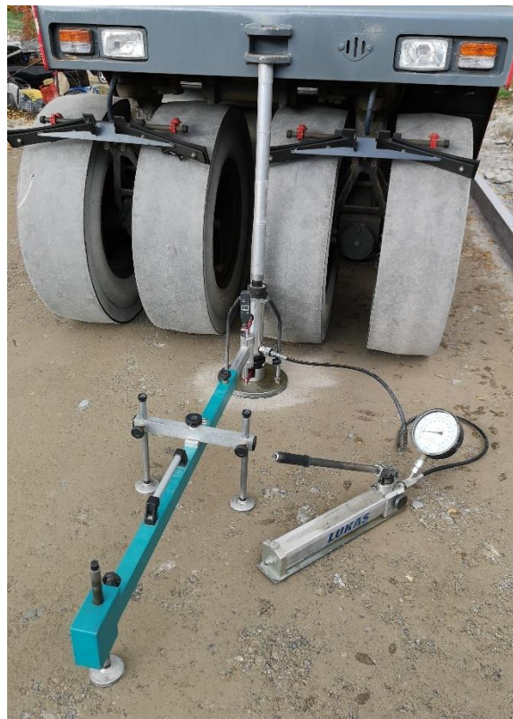
Figura 6. Ensayo de placa de carga
