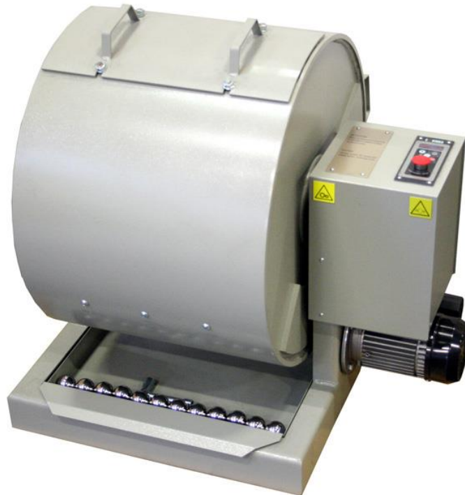
Figura 19. Máquina de abrasión de los ángeles
