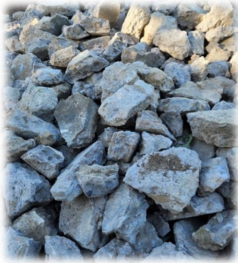
Figura 21. Escombros de concreto
