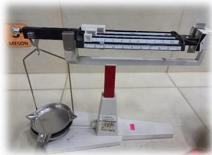
Fotografía 23 Peso de muestra de cemento retenido en el tamiz N° 40 y 200
