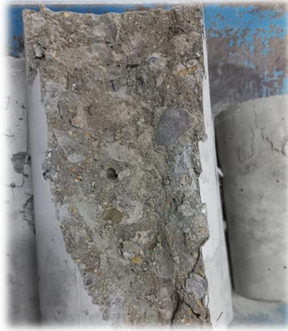
Fotografía 42 Vista de la rotura de probeta cilíndrica
