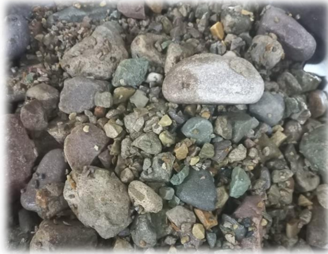
Fotografía 19 Material lavado retenido en tamiz N° 12
