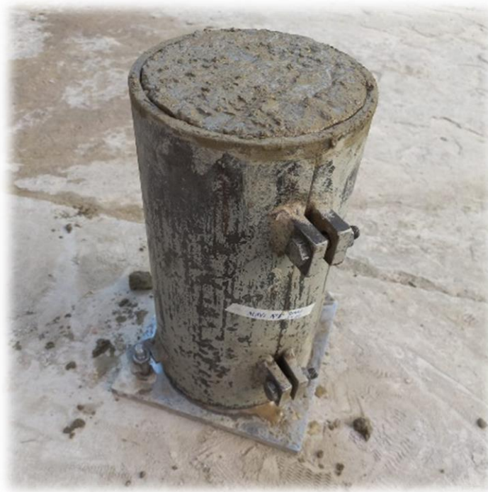
Fotografía 37 Llenado del hormigón en molde.
