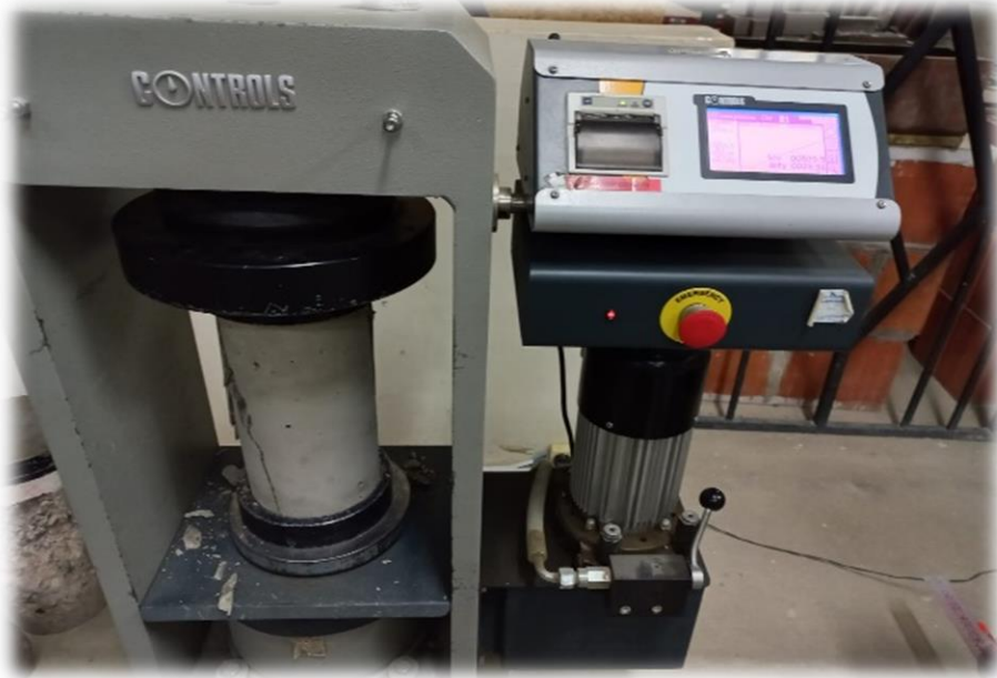
Fotografía 40 Probeta sometida a la fuerza de compresión.
