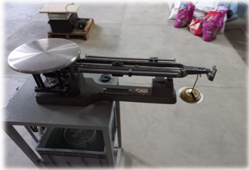
Fotografía 11 Agregado grueso sumergido en cesto metálico
