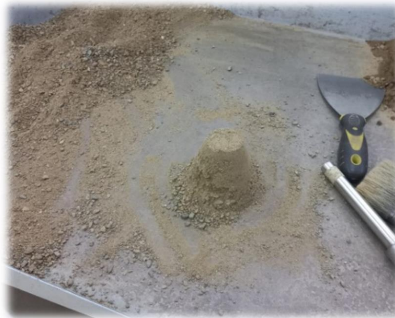
Fotografía 6 Control de humedad óptima de la muestra de agregado fino
