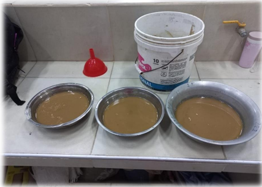
Fotografía 9 Muestras en recipientes antes de entrar al horno
