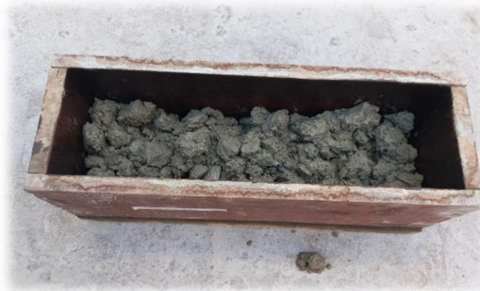
Fotografía 35 Llenado del hormigón en los moldes correspondientes
