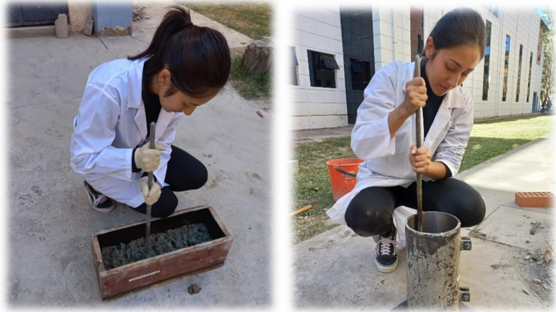
Fotografía 36 Compactación de la mezcla por capas
