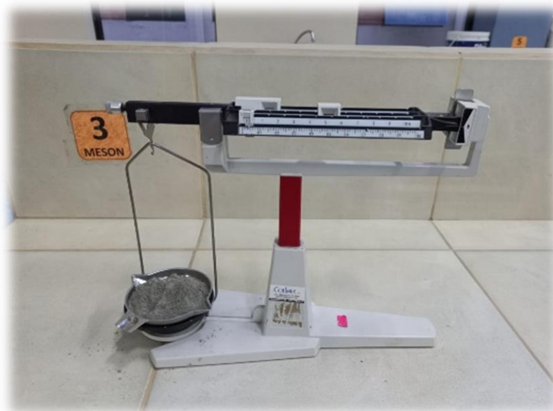
Fotografía 22 Muestra de 50 gr de cemento
