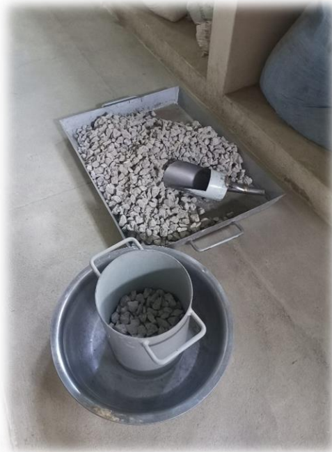
Fotografía 16 Peso unitario compactado del agregado grueso
