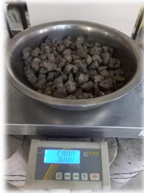
Fotografía 10 Agregado grueso saturado superficialmente seco
