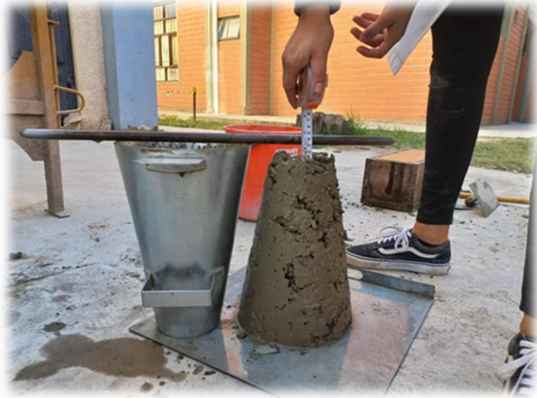
Fotografía 34 Medición del asentamiento de la mezcla
