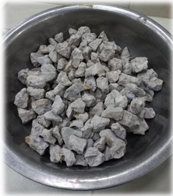
Fotografía 12 Agregado grueso secado en horno
