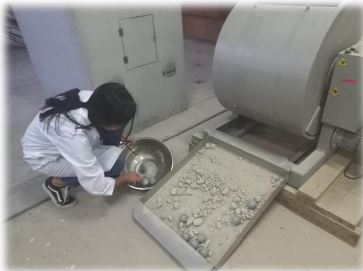
Fotografía 18 Recolección del material después del proceso de desgaste
