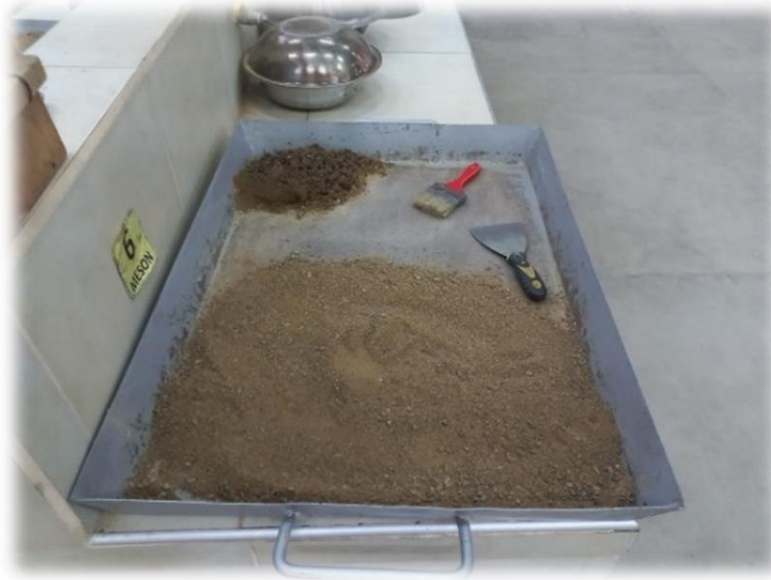
Fotografía 5 Muestra de agregado fino saturada
