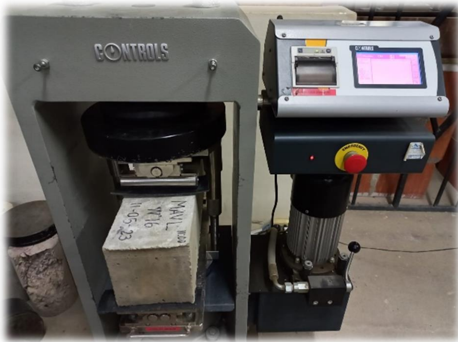
Fotografía 43 Viga sometida a la fuerza de flexotracción.
