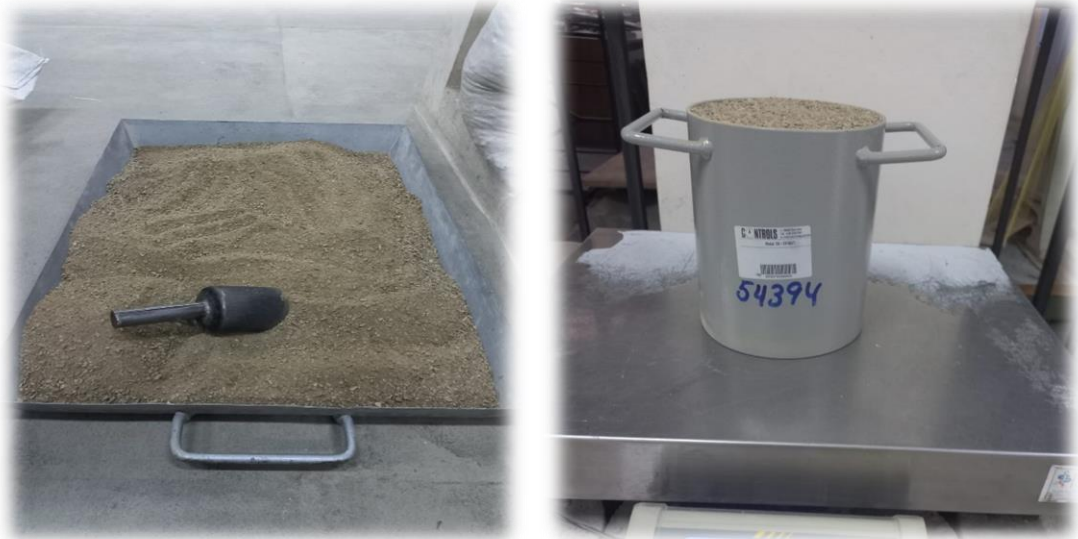
Fotografía 13 Peso unitario suelto del agregado fino
