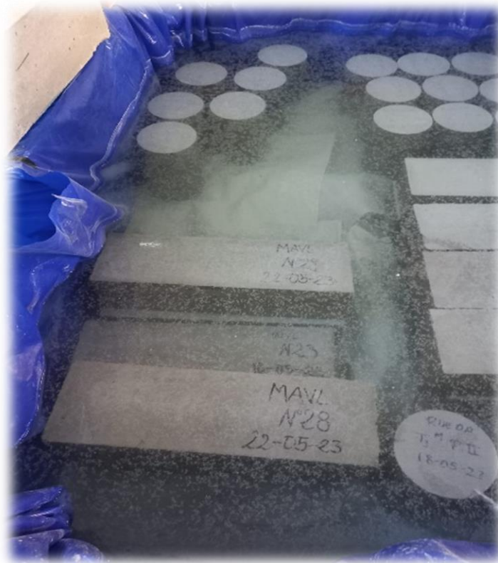
Fotografía 39 Probetas en su proceso de fraguado
