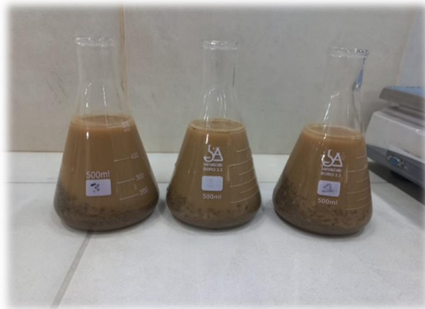
Fotografía 8 Matraz con la muestra y agua hasta la marca de calibración
