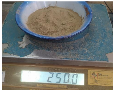
Preparando y pesando la muestra de suelo para el ensayo
