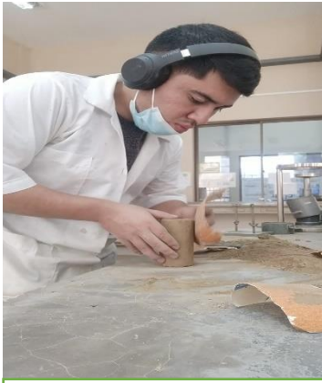
Tallando la muestra en las dimensiones requeridas
