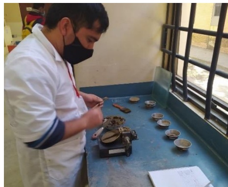
Realizando la ranura y accionando la copa de Casagrande
