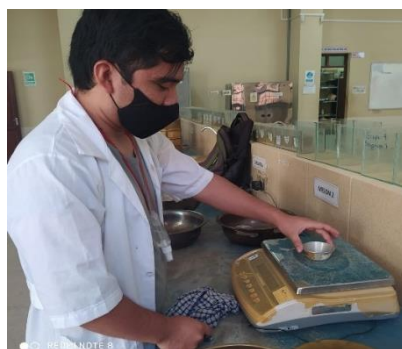
Pesando la tara con muestra de suelo
