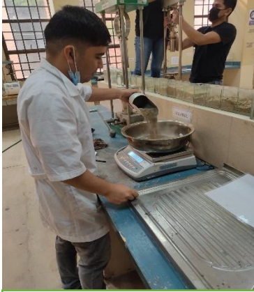
Pesando una muestra y preparando para su compactación
