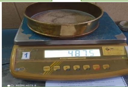
Pesando las muestras retenidas en los tamices
