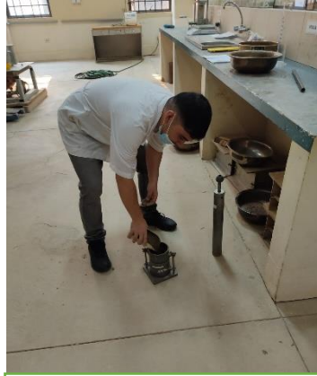
Introduciendo la muestra al molde de compactación
