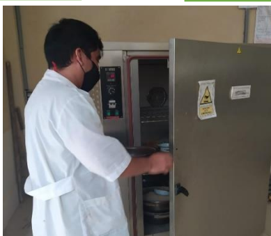
Llevando las taras al horno por 24 hora, para luego pesar nuevamente
