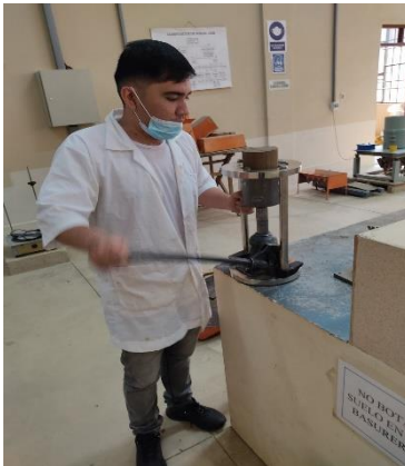
Realizando la extracción de la muestra
