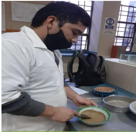
Sometiendo al frasco con el suelo a baño maría hasta los 60° C
