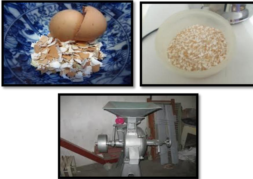
La pulverización se lo realiza mediante una máquina, como se observa en la imagen que la misma funciona a energía eléctrica.
