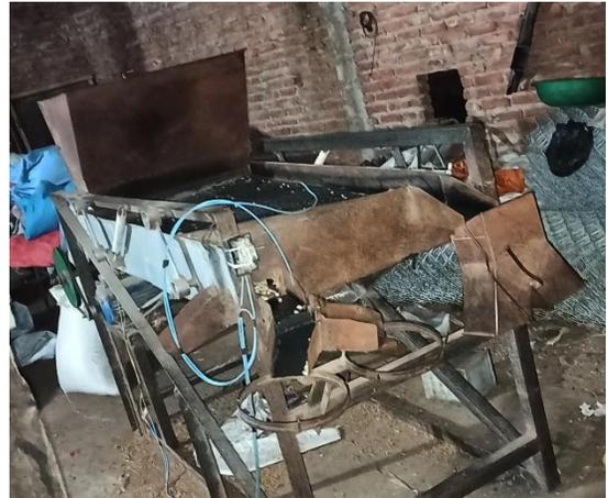
**Secadora:** La máquina tiene una medida de 2m x 1m, con una antigüedad de 4 años, consiste en secar el maní blanco, que tiene la capacidad para 18 quintales, se controla con un medidor de temperatura, funciona con electricidad y gas, el tiempo que demora en secar el maní aproximadamente es de 12 horas. Se encuentra ubicada en el galpón 2, que se muestra en la siguiente imagen:
