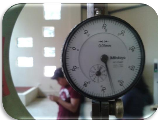
Lectura del extensómetro durante la rotura de probetas. [Imagen 52]
