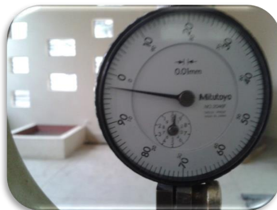
Lectura del extensómetro durante la rotura de probetas. [Imagen 52]
