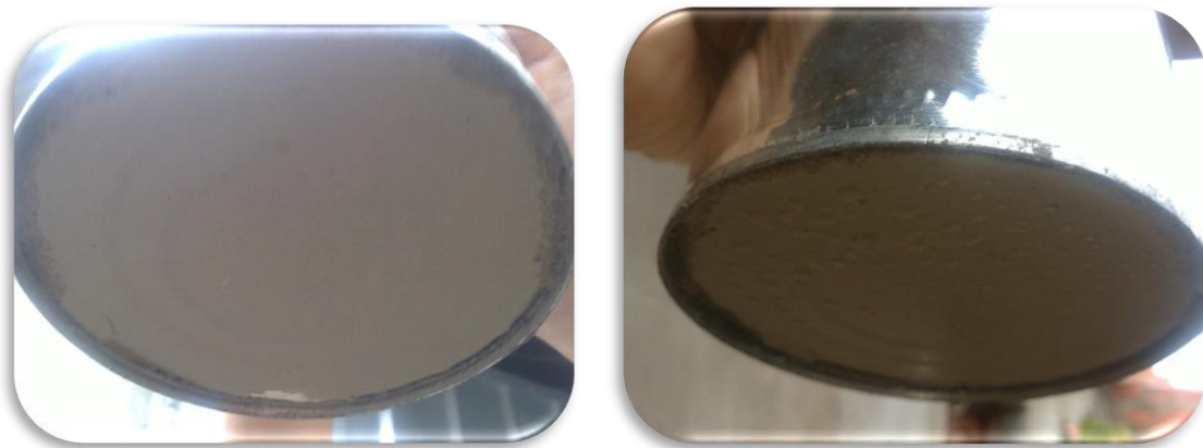
Visualización de la filtración del agua a través del suelo-cemento. [Imagen 36].
