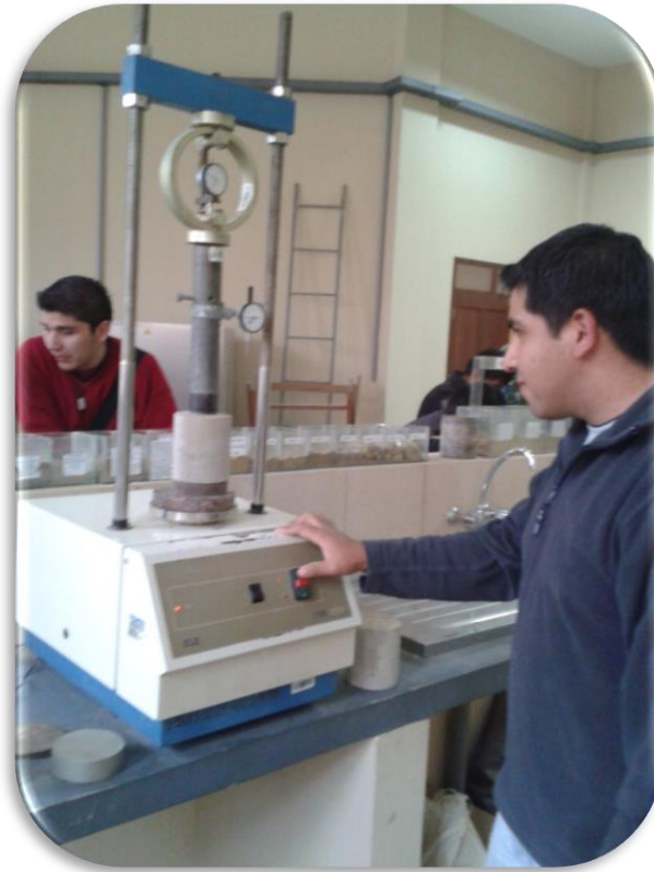
Rotura de probetas en la prensa CBR. [Imagen 51]
