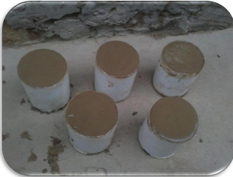
Vaciado de las probetas de suelo-cemento para la muestra patrón. [Imagen 41]
