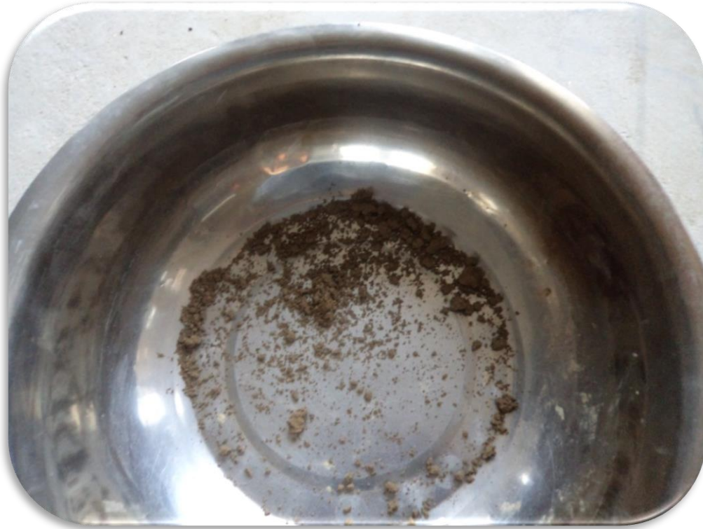
Pulverización del bolo de suelo-cemento cuando cae desde una altura de 1 m. [Imagen. 17]
