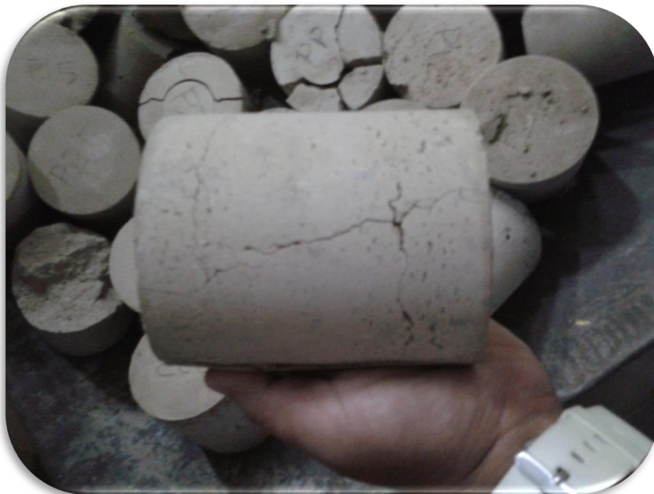
Visualización de las fisuras en las probetas luego de la realización del ensayo. [Imagen 54]
