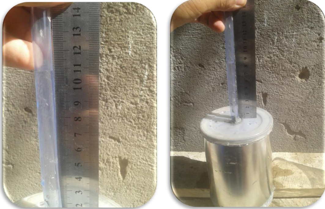
Medición de la altura de la columna de agua en el equipo de permeabilidad. [Imagen 38].
