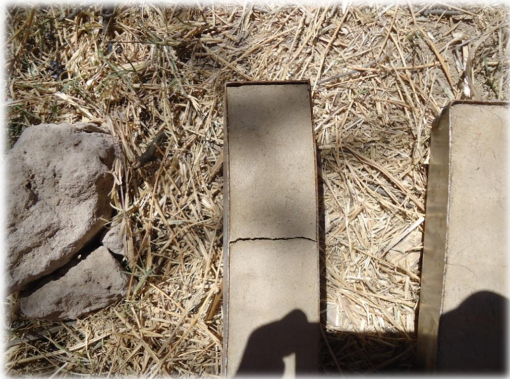
Retracción y fisuras del suelo-cemento para la muestra patrón. [Imagen 23]
