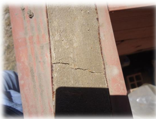
Visualización de pequeñas fisuras en el suelo-cemento que contiene fibras de pelo de chivo. [Imagen 29]
