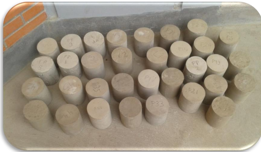
Probetas de suelo-cemento para la realización del ensayo. [Imagen 49]
