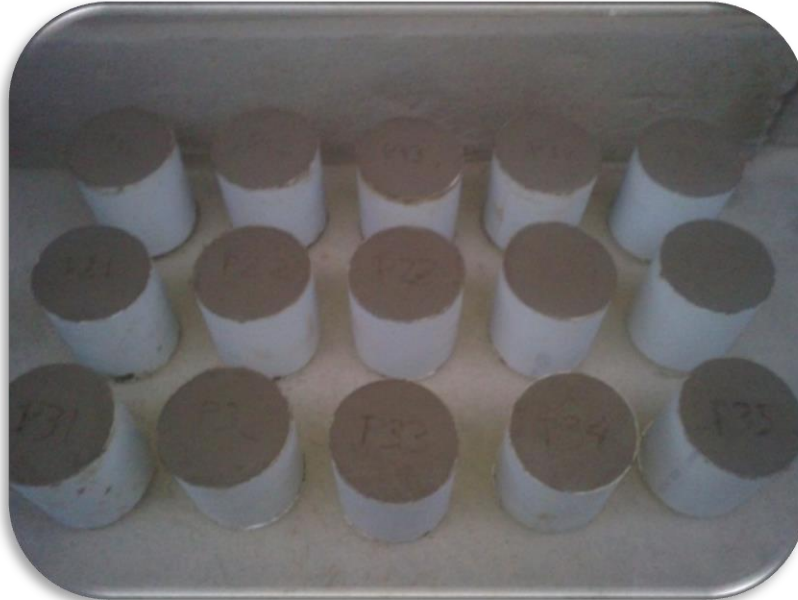
Vaciado del suelo-cemento al cual se le ha aplicado fuerzas externas. [Imagen 44]
