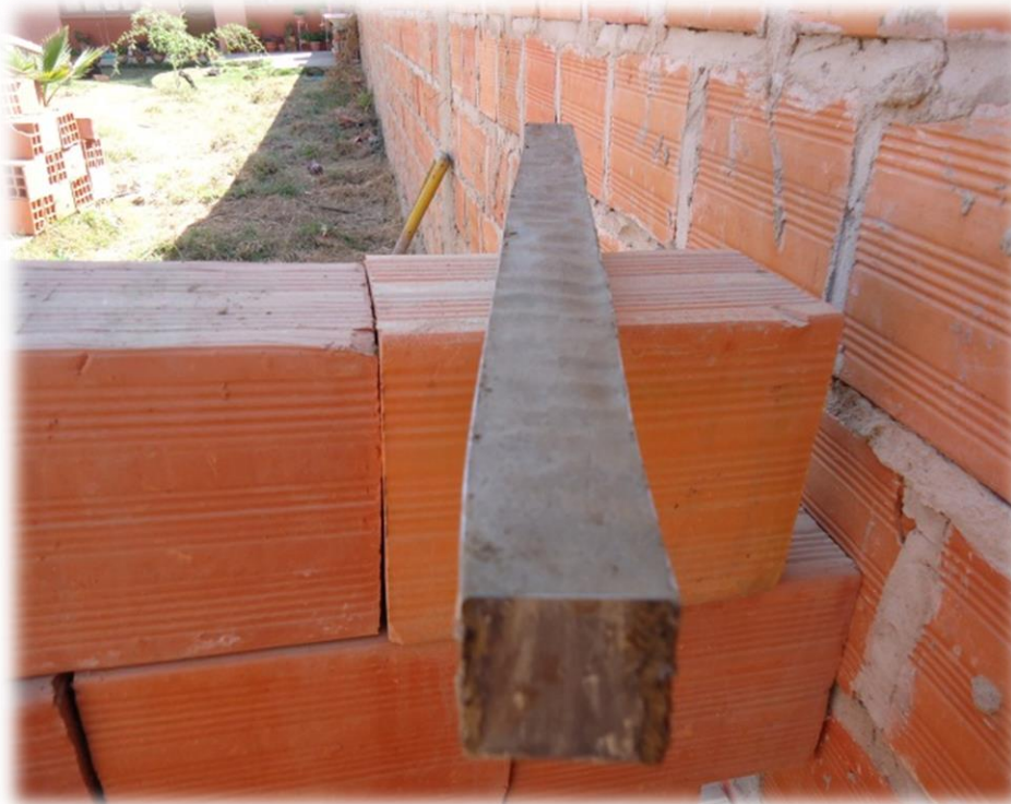
Moldes del ensayo de retracción llenados con mezcla de suelo-cemento de dosificación 1:10. [Imagen 20]
