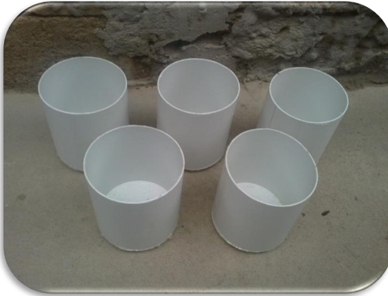
Moldes plásticos para el ensayo de compactación. [Imagen 39]
