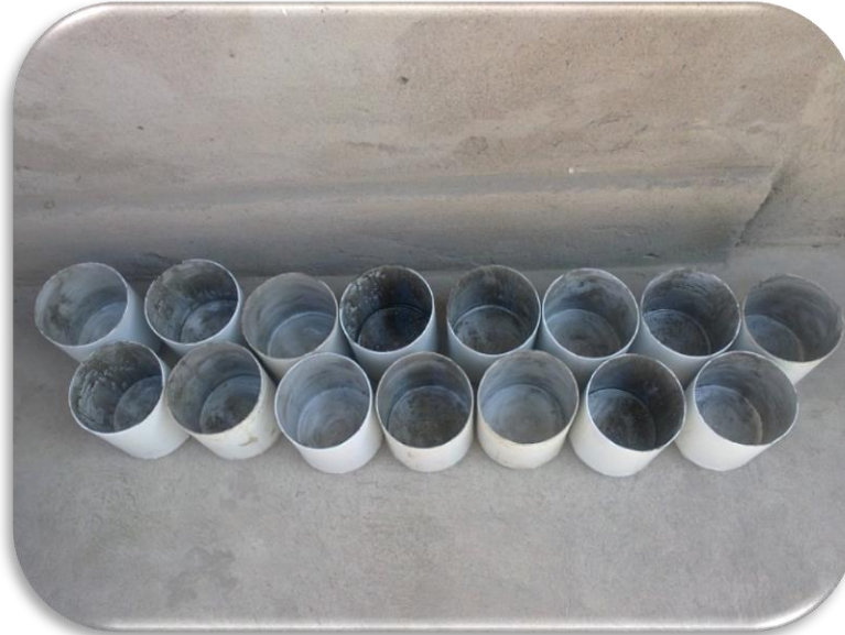
Engrasado de los moldes del ensayo de compactación. [Imagen 43]
