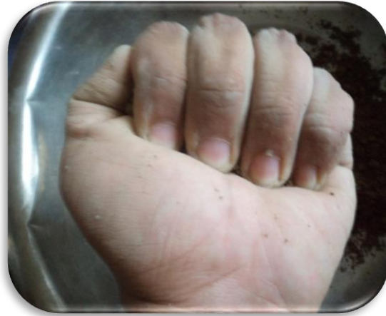
Realización del apretado de la mezcla de suelo-cemento. [Imagen. 14]
