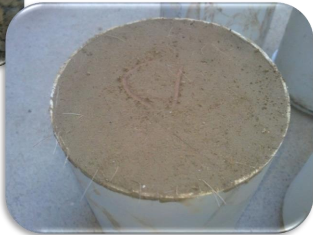
Elaboración de las probetas de suelo-cemento que contienen aceite de linaza y pelo de chivo. [Imagen 47]
