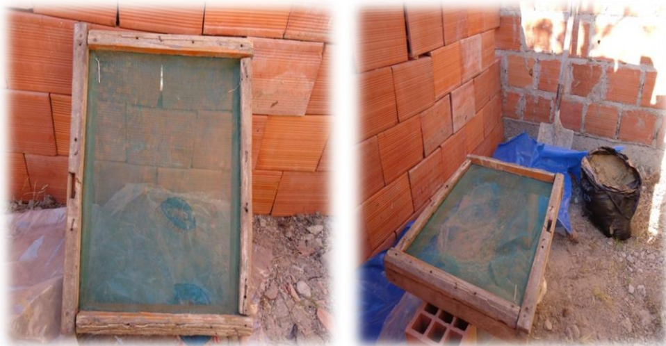
Mallas y bastidor para realizar el tamizado. [Imagen. 5]
