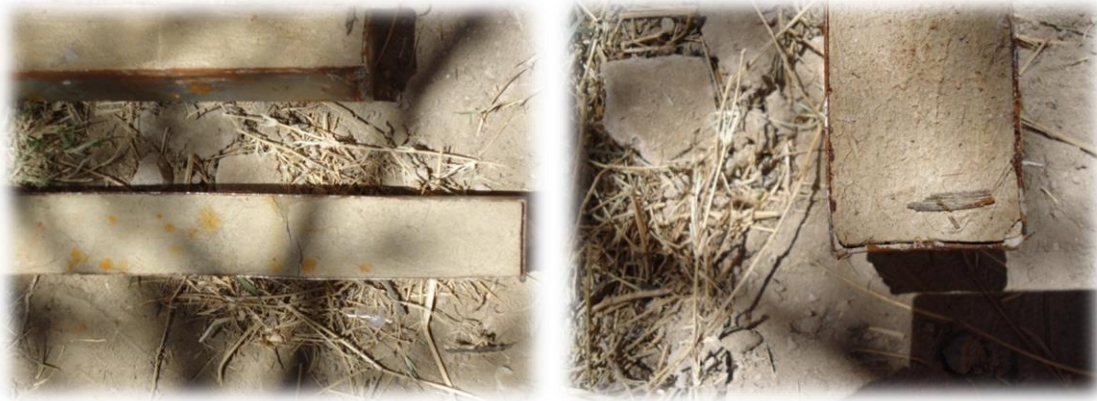
Visualización de pequeñas fisuras en el suelo-cemento que contiene fibras de pelo de chivo. [Imagen 30]
