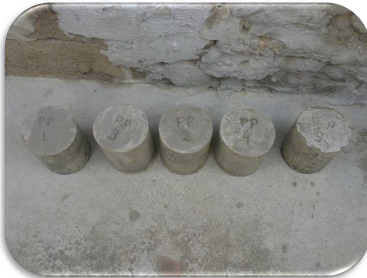
Fraguado de las probetas de suelo-cemento para la muestra patrón. [Imagen 42]
