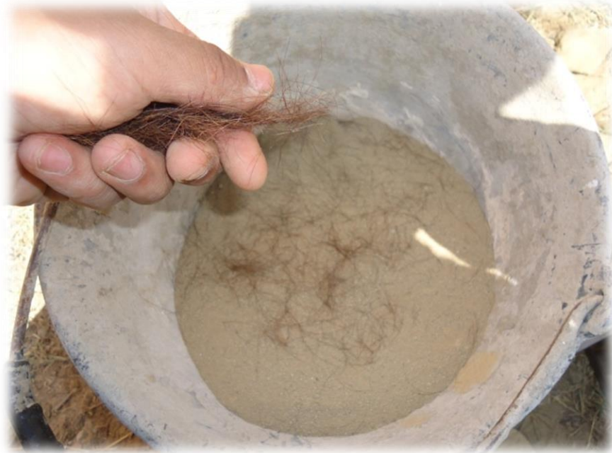
Incorporación de las fibras de pelo de chivo a la mezcla de suelo-cemento. [Imagen 26]
