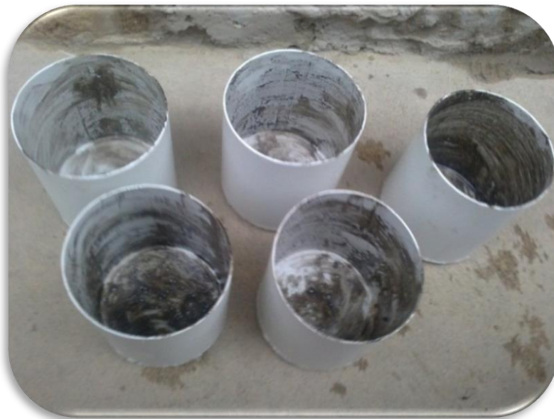
Engrasado de los moldes plásticos para el ensayo de compactación. [Imagen 40]
