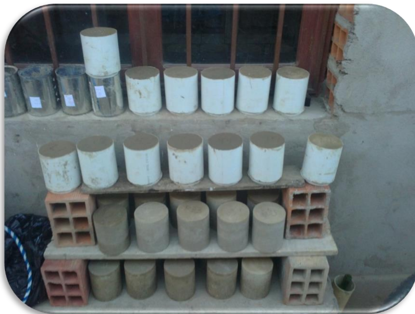
Fraguado y curado de las probetas de suelo-cemento. [Imagen 46]
