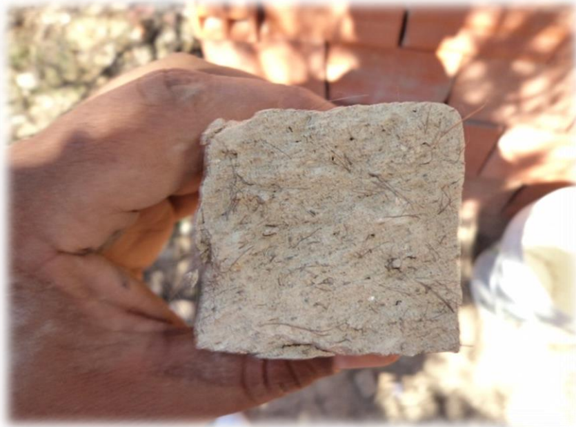
Visualización de la distribución del pelo de chivo en la masa de suelo-cemento. [Imagen 32]
