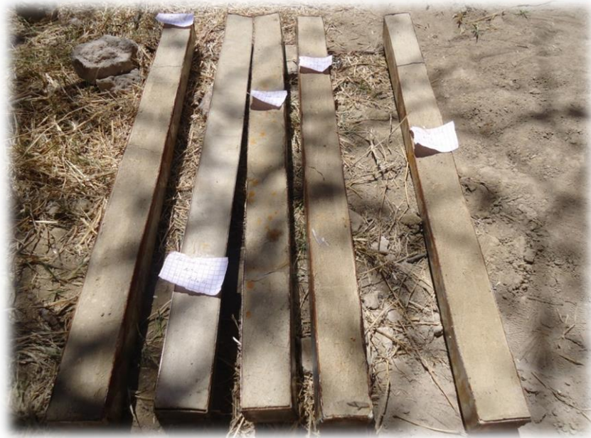
Fraguado y curado de la mezcla de suelo-cemento en los moldes del ensayo de retracción. [Imagen 21]
