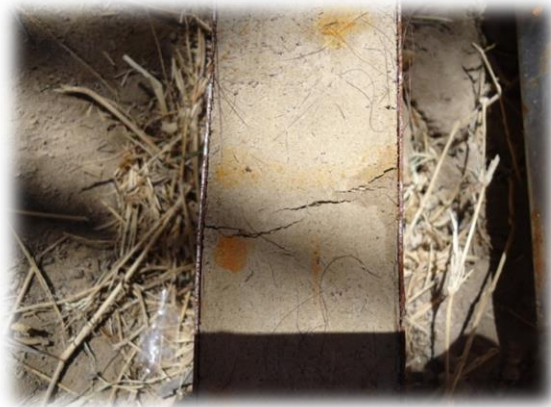
Visualización de pequeñas fisuras en el suelo-cemento que contiene fibras de pelo de chivo. [Imagen 29]
