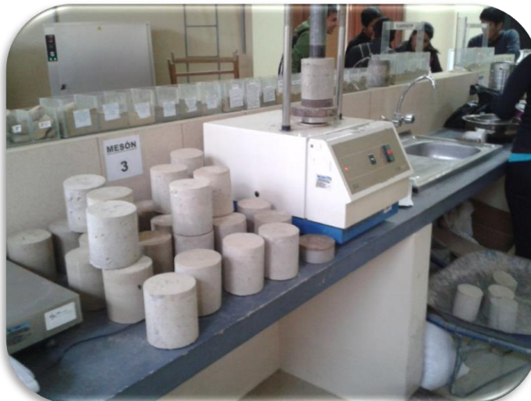
Rotura de probetas en la prensa CBR. [Imagen 50]
