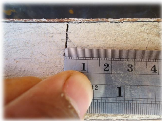
Medición de las fisuras en el suelo-cemento que contiene fibras de pelo de chivo. [Imagen 31]
