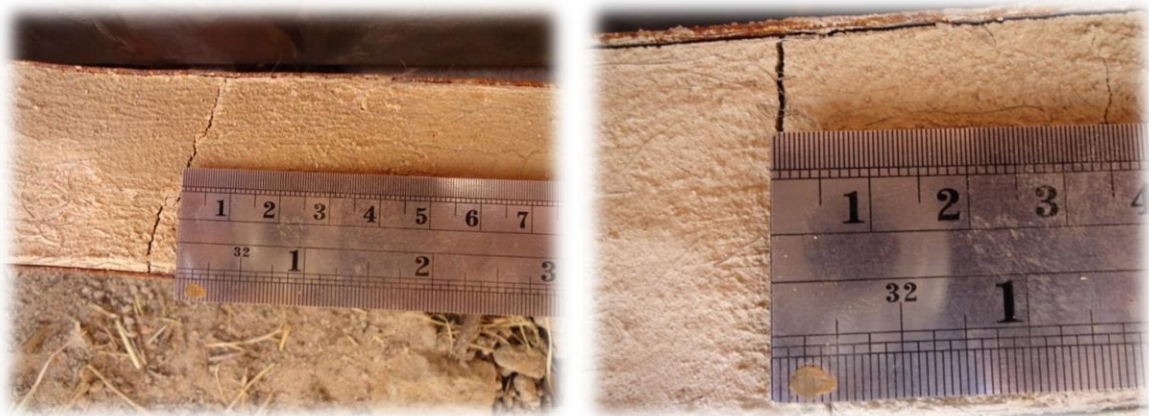
Visualización de pequeñas fisuras en el suelo-cemento que contiene fibras de pelo de chivo. [Imagen 30]
