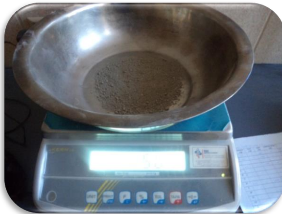
Pesaje del cemento en la balanza con precisión de 0,1 gr. [Imagen. 9]
