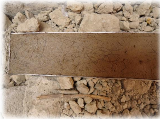
Vaciado y enrasado de la mezcla de suelo-cemento con pelo de chivo en los moldes de retracción. [Imagen 28]
