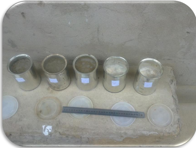
Fraguado y curado del suelo-cemento en los moldes del ensayo de permeabilidad. [Imagen 34].
