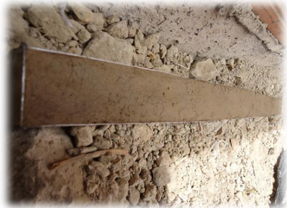
Vaciado y enrasado de la mezcla de suelo-cemento con pelo de chivo en los moldes de retracción. [Imagen 28]
