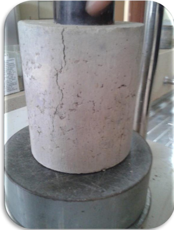
Aparición de las fisuras en el momento de la rotura de la probeta. [Imagen 53]
