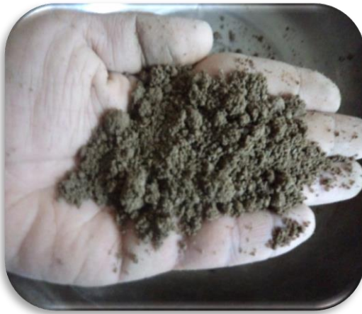
Realización del apretado de la mezcla de suelo-cemento. [Imagen. 14]
