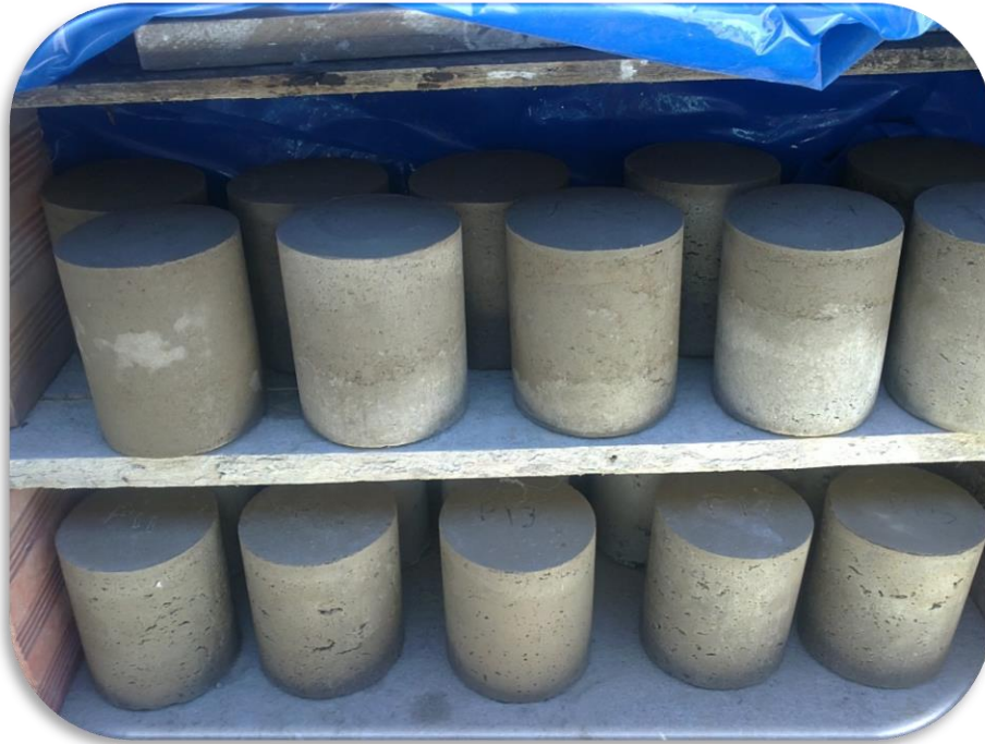
Fraguado y curado de las probetas de suelo-cemento. [Imagen 45]
