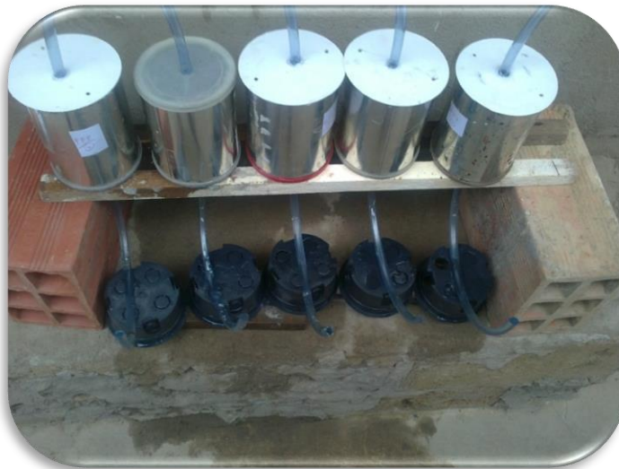
Llenado con agua de los equipos del ensayo de permeabilidad. [Imagen 37].
