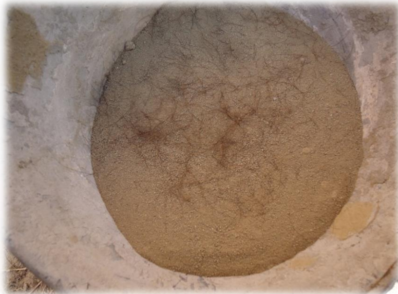
Incorporación de las fibras de pelo de chivo a la mezcla de suelo-cemento. [Imagen 27]
