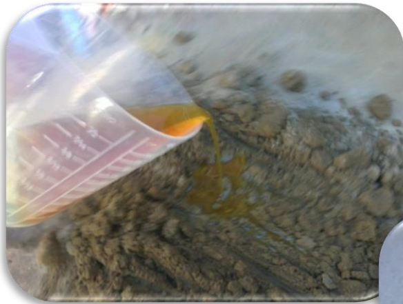
Elaboración de las probetas de suelo-cemento que contienen aceite de linaza y pelo de chivo. [Imagen 47]
