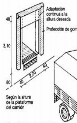
12 Estanquidad perimetral con protecciones de goma
