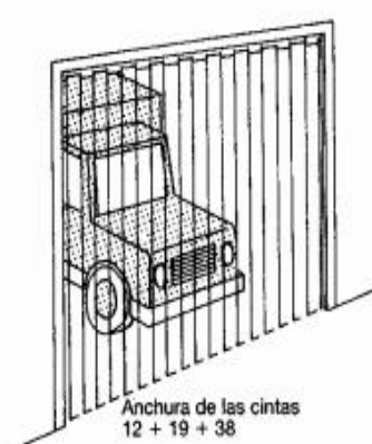
10 Cortina de cintas de PVC para el paso de grandes vehículos
