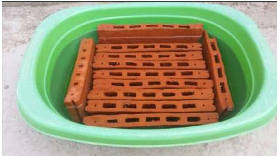
Pesadas las piezas y secadas, con precisión 0,01 g, se colocan en un calentador lleno de agua sin que se lleguen a tocar unas con las otras, de manera que el nivel del agua, por encima y por debajo de las baldosas, sea de 5 cm.
