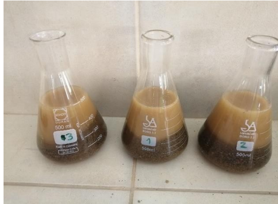
Figura 20. Peso de la arena humedad óptima, peso del matraz +Agua
