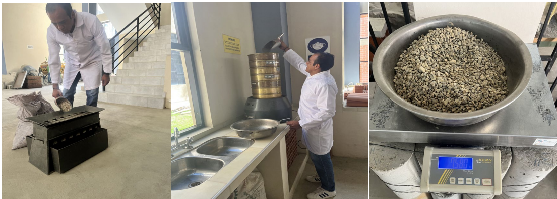
Figura 14. Granulometría de los agregados (Grava (3/4"), gravilla (3/8") y arena).
