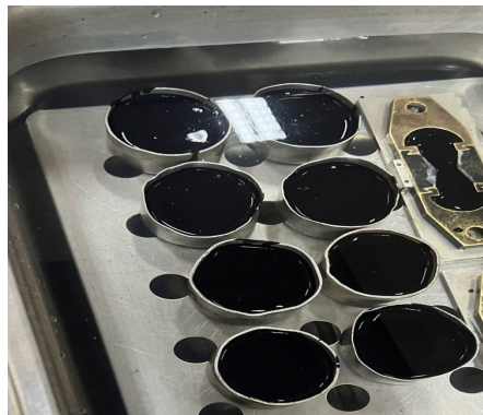
Figura 38. 25° C cemento asfaltico sumergido.
