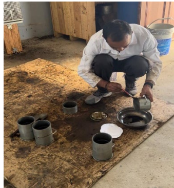
Figura 57. Lubricando de los anillos con papel y aceite
