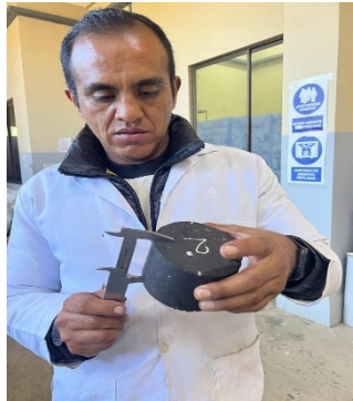
Figura 62. Tomado de medidas de las briquetas
