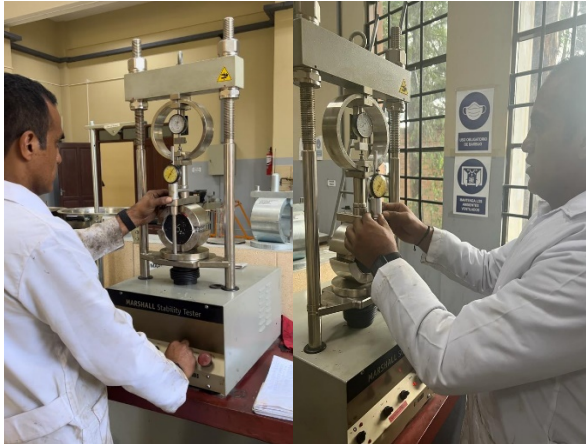
Figura 66. Lectura del dial de estabilidad (dentro del anillo Marshall) y el dial de deformación para el flujo
