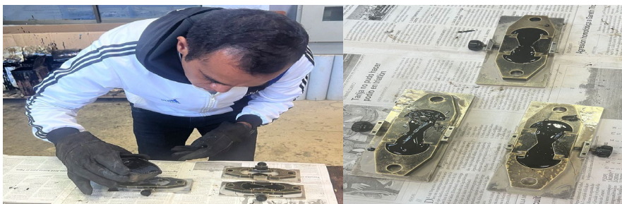
Figura 42. Llenado de moldes con cemento asfáltico
