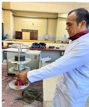
Figura 61. Desmoldado de briquetas después del reposo
