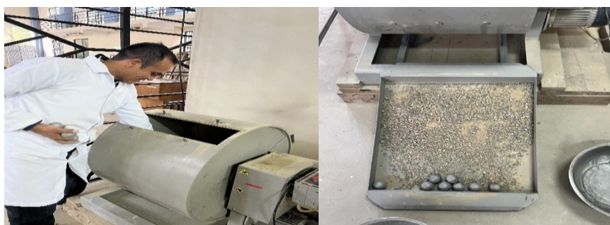
Figura 28. Máquina de desgaste de los ángeles
