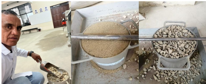
Figura 23. Peso del volumen del molde
