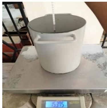
Figura 23. Peso del volumen del molde
