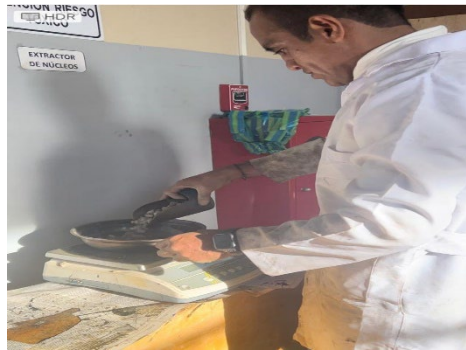
Figura 51. Pesado de los agregados (grava, gravilla, arena, Filler y caucho reciclado)
