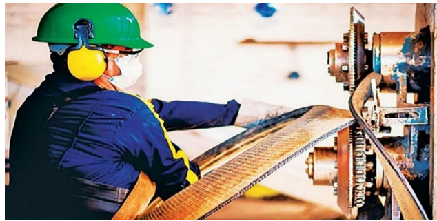
Figura 6. Removido de laterales de los neumáticos
