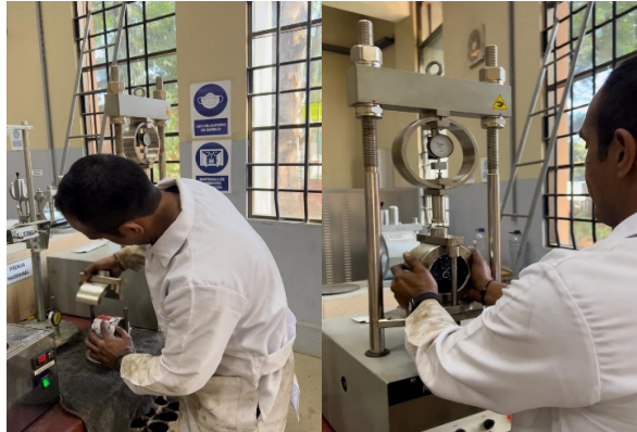
Figura 65. Colocado de briquetas a la mordaza Marshall
