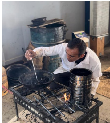
Figura 56. Mezclado y control de temperatura de la muestra
