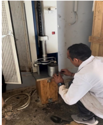
Figura 59. Introducido la muestra al Martillo eléctrico
