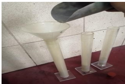
Figura 29. Enrasado fino hasta la línea de referencia
