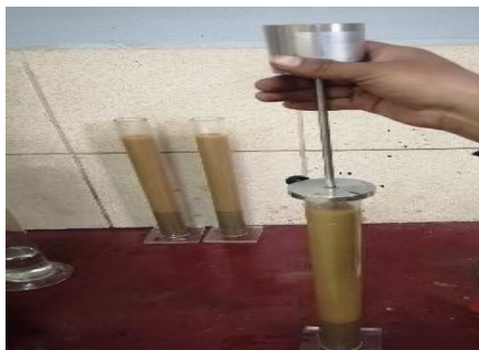
Figura 31. Eliminación de aire de la probeta.
