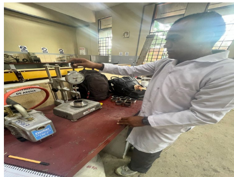
Figura 40. Medición punto de penetración
