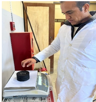
Figura 63. Pesado de las briquetas
