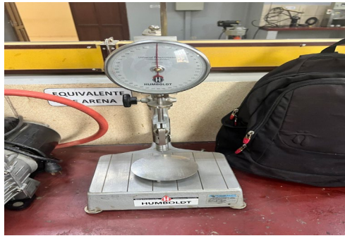
Figura 39. Aparató para la medición Punto de penetración
