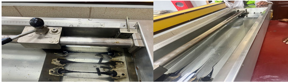
Figura 43. Medición de la ductilidad del cemento asfáltico
