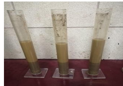
Figura 30. Llenado de agua destilada más reactivo mezclado
