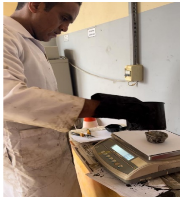
Figura 54. Pesado del cemento asfáltico
