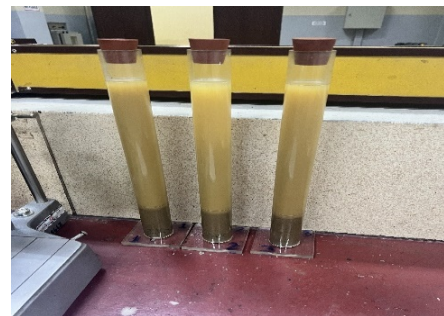
Figura 32. Enrasado de Agua destilada hasta la línea de referencia.
