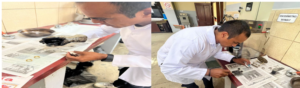
Figura 49. Llenado de los anillos con cemento asfáltico
