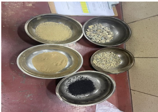
Figura 52. Pesado de agregados más caucho reciclado
