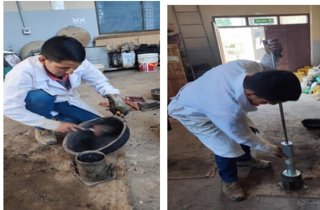
Figura 3.40. Vertiendo la mezcla asfáltica y proceso de compactación
