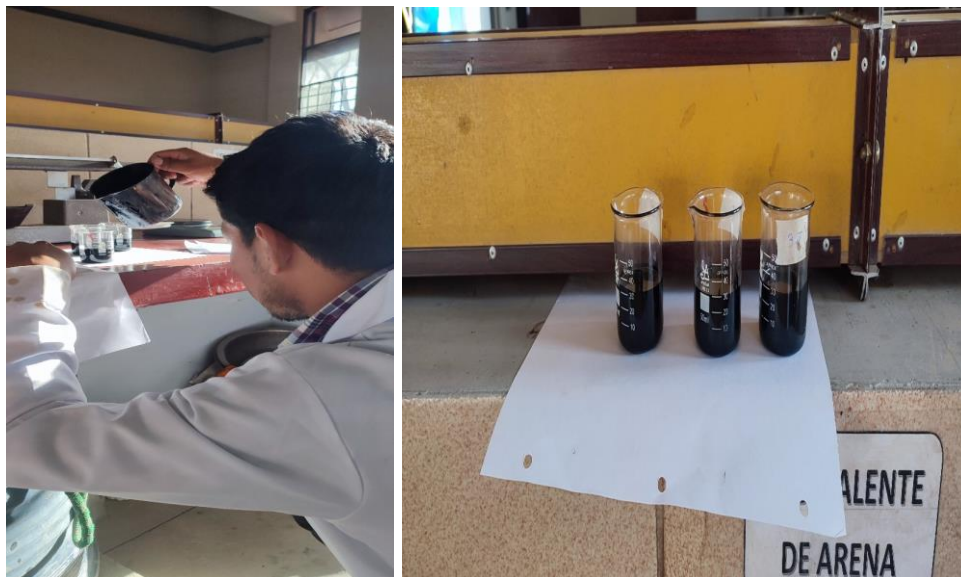
Figura 3.33. Vertiendo cemento asfáltico al picnómetro y muestras
