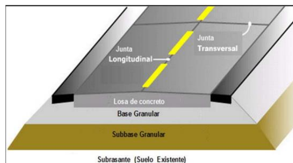
Figura 2.4. Estructura pavimento rígido
