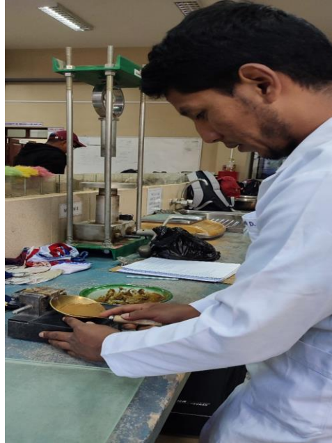
Figura 3.16. Muestra Casa Grande del agregado de capa sub base
