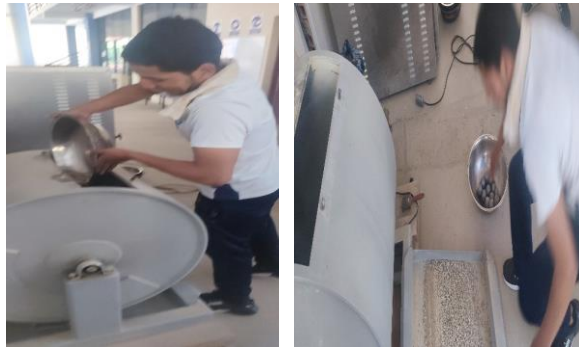
Figura 3.25. Introduciendo el material y esferas al tambor del desgaste
