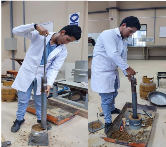
Figura 3.19. Proceso de compactación
