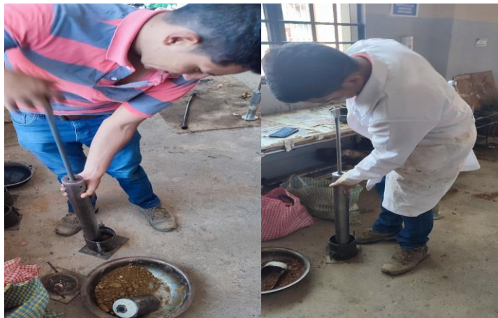
Figura 3.39. Compactación de las mezclas de agregados
