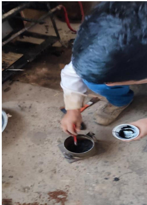
Figura 3.43. Riego de liga en las probetas de ensayo
