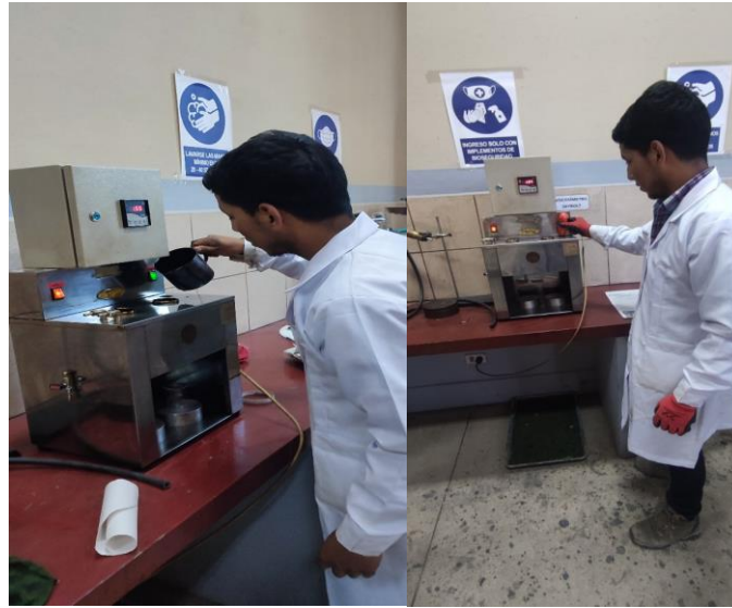
Figura 3.28. Cemento asfáltico en recipiente y mezclado del aceite del equipo
