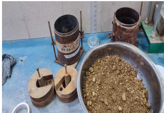
Figura 3.20. Muestras y moldes para en ensayo de CBR
