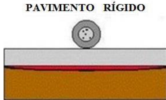
Figura 2.1: Absorción de esfuerzo que se ejerce sobre el pavimento
