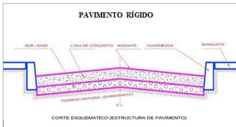
Figura 2.2: Corte esquemático con cada una de las partes de un pavimento rígido
