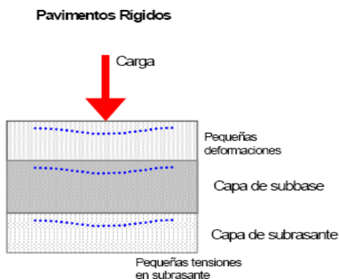
Figura 2.3: Pavimento rígido sometido a una carga
