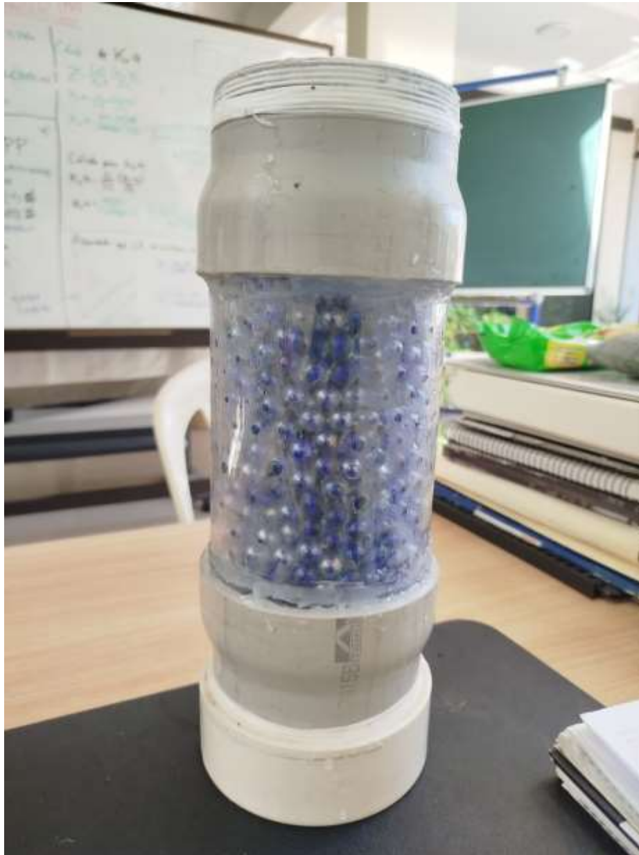
Fotografía 2-3. Construcción de módulo con relleno de esferas de vidrio
