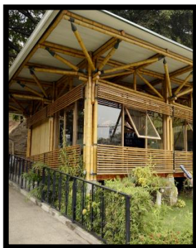
Columnas de bambú o madera resistente (cedro)
