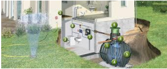
Figura 11: Captador de Agua de Lluvia / Fuente: Pinterest
