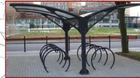
PARADA DE BICICLETAS CONSTRUIDO EN BASE A BARRAS Y ARCOS METÁLICOS Y UNA CUBIERTA DE POLICARBONATO. ESTA CUMPLE LA FUNCIÓN DE RESGUARDAR LAS BICICLETAS EN UN LUGAR SEGURO Y BAJO UNA SOMBRA.
