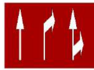
FLECHAS DE DIRECCIONAMIENTO EN CICLOVÍA
