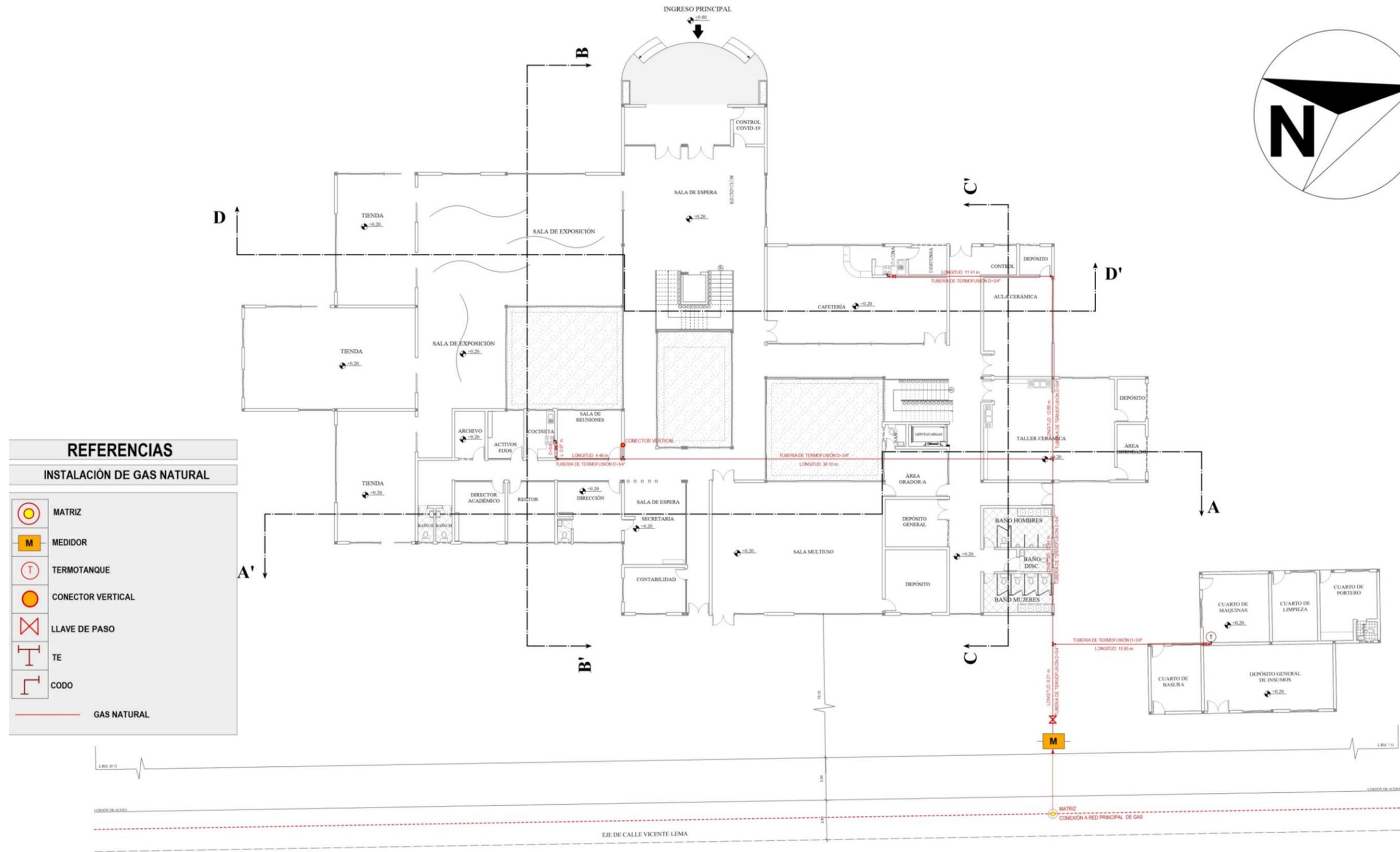
PLANO DE INSTALACIÓN DE GAS - PLANTA BAJA
