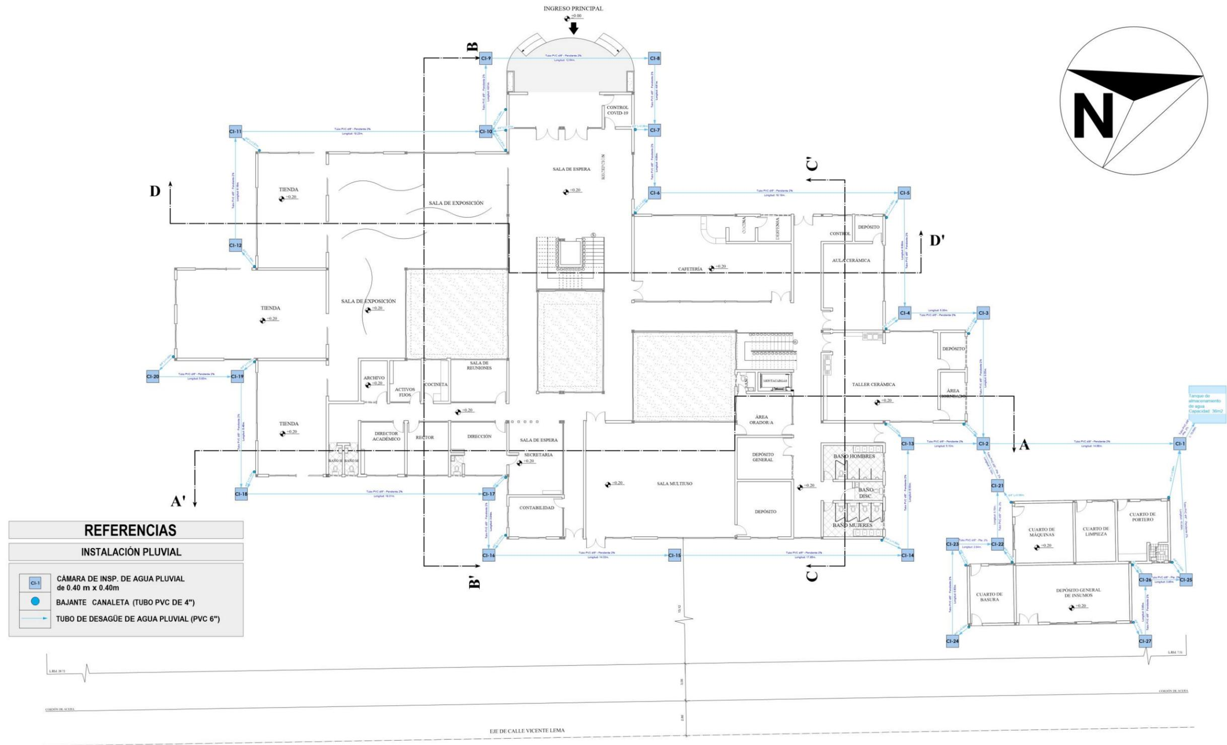
PLANO DE INSTALACIÓN DE ALCANTARILLADO PLUVIAL - PLANTA BAJA
