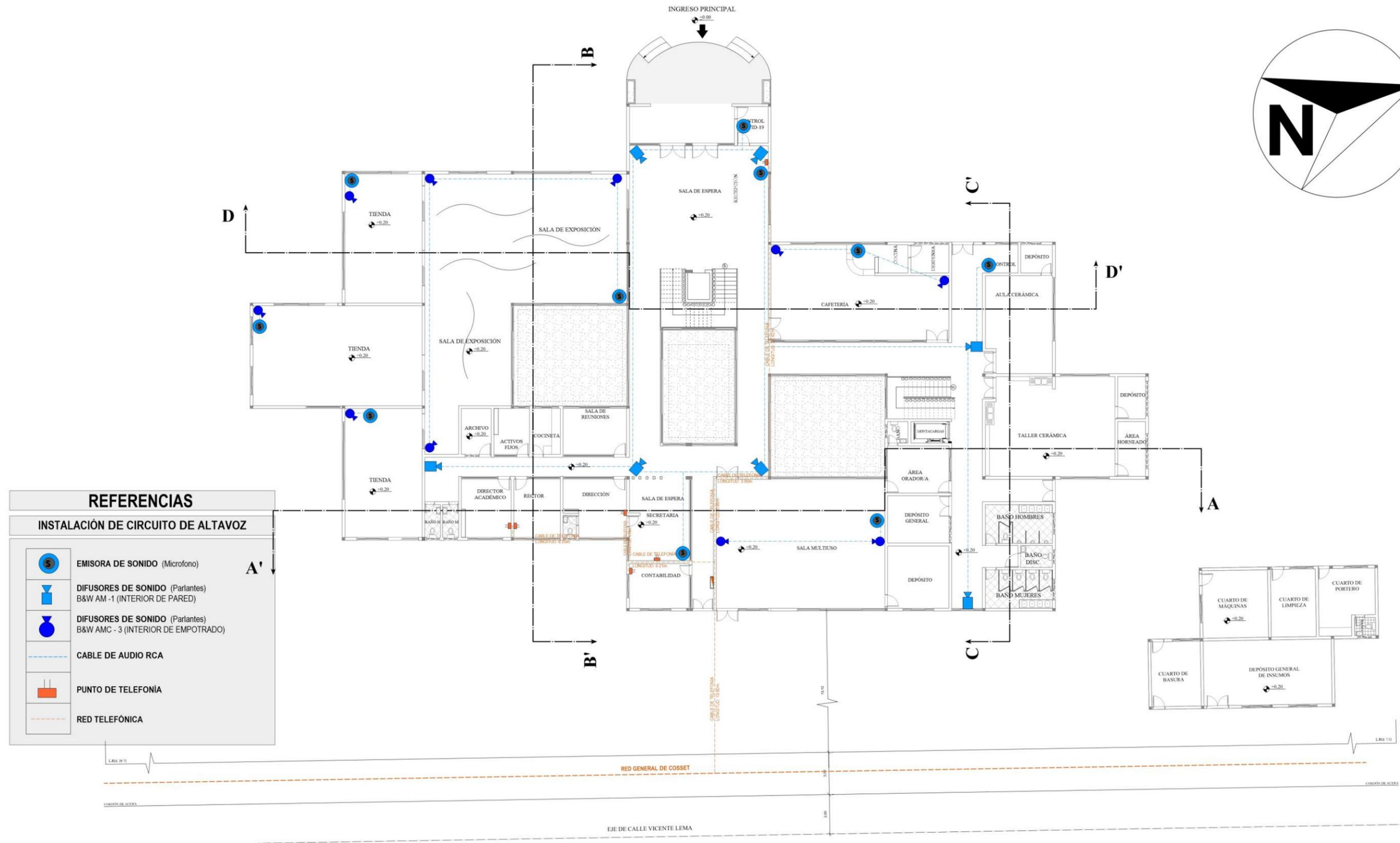
PLANO DE INSTALACIÓN DE CIRCUITO DE ALTAVOZ Y TELEFONÍA - PLANTA BAJA
