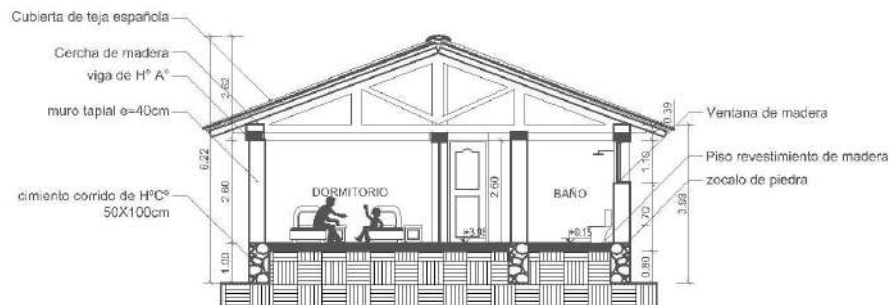
CABAÑA T2 CORTE B-B ESC. 1:100
