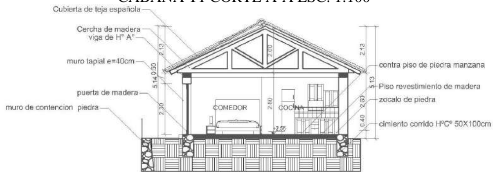
CABAÑA T1 CORTE B-B ESC. 1:100
