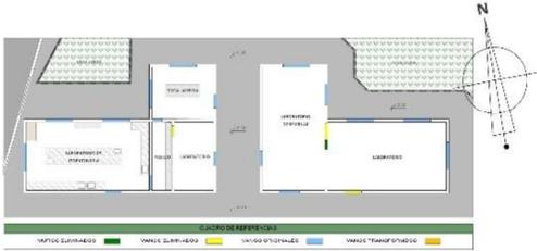
**PLANTA DE ADICIÓN Y SUSTRACCIÓN DE MUROS Y VANOS BLOQUE B**
