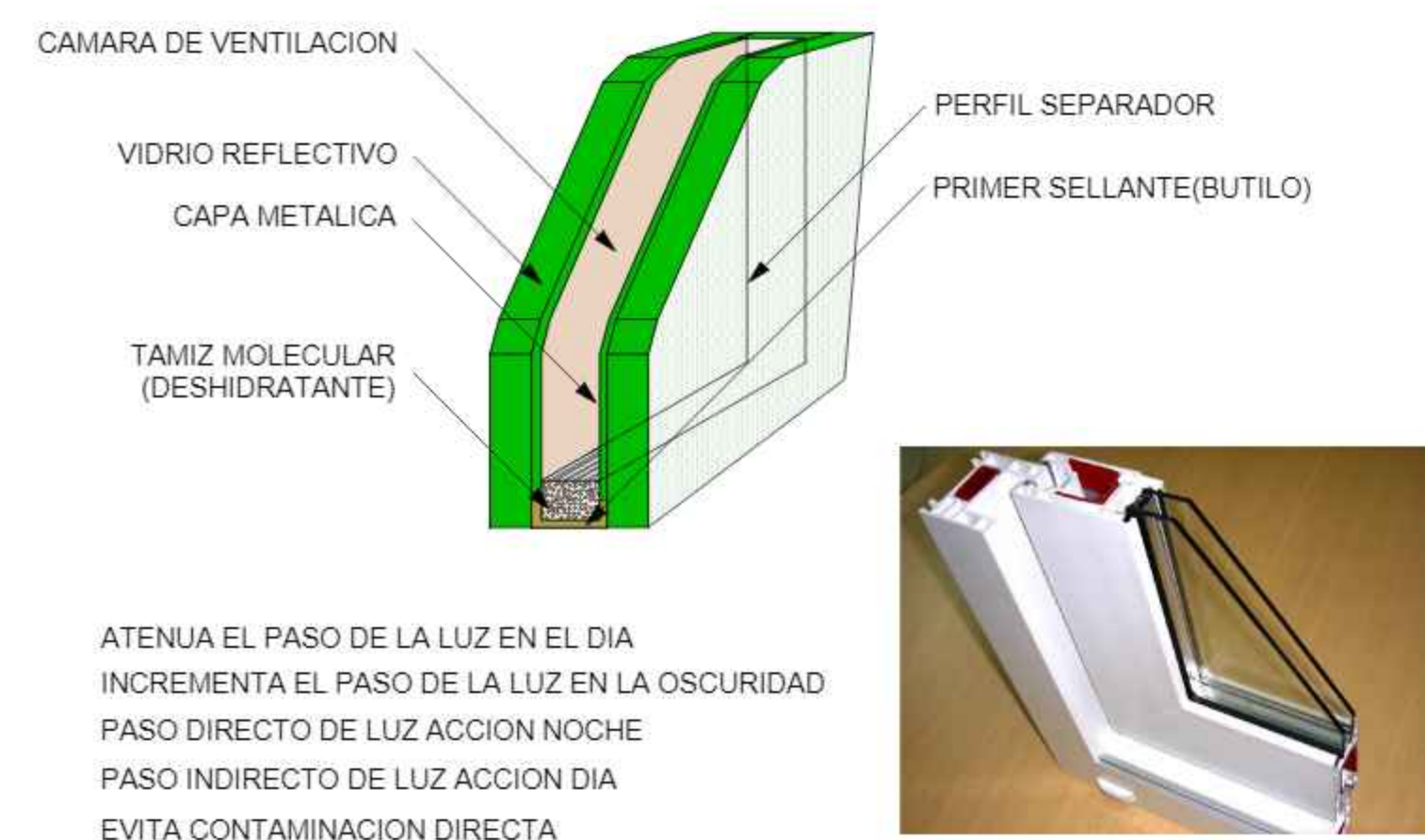
DETALLE DE FACHADA DE DOBLE VIDRIO
