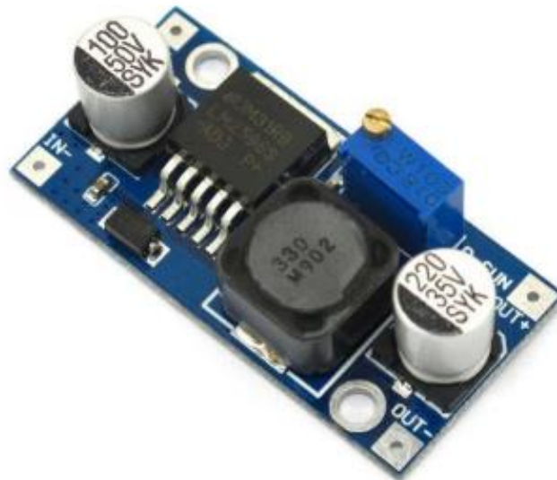
Figura 57: Figura. LM2596 Regulador Step-Down
